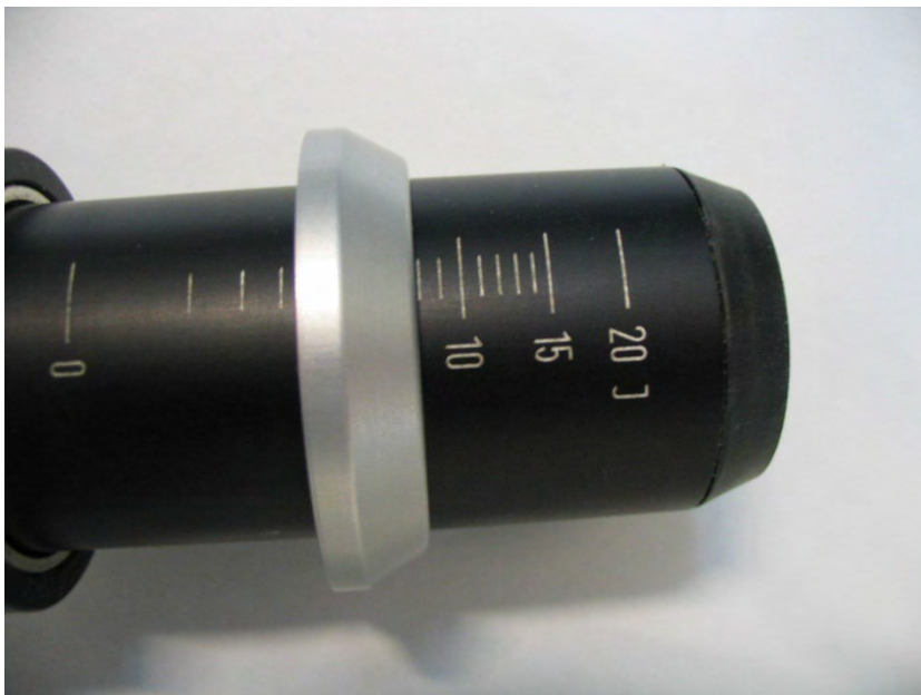
Energiemessung hier z.B. 8 Joule
