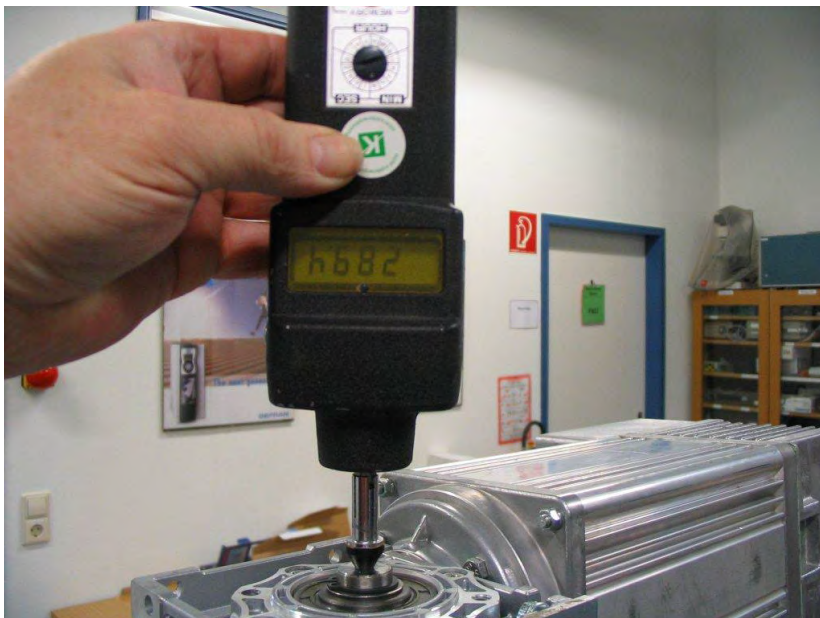
Drehzahlmessung am Getriebeabtrieb
