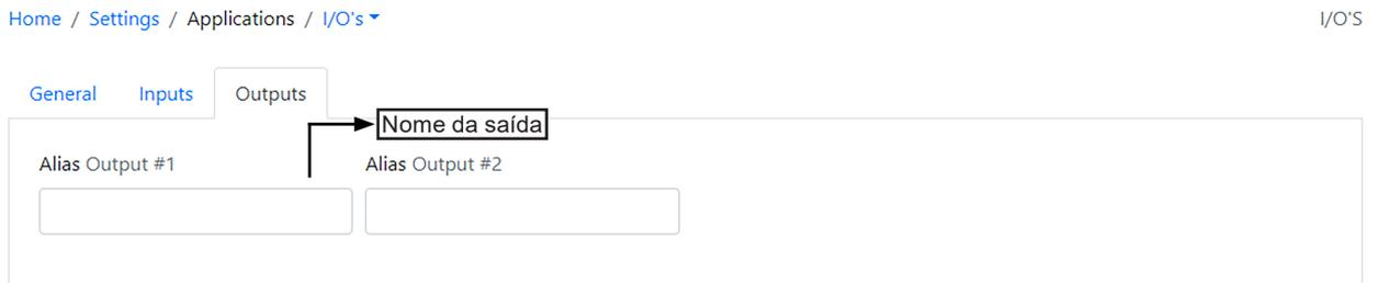
**Figura 3.31:** Configuração das saídas digitais
