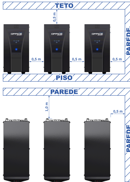
Figura 5.2: Layout de instalação
