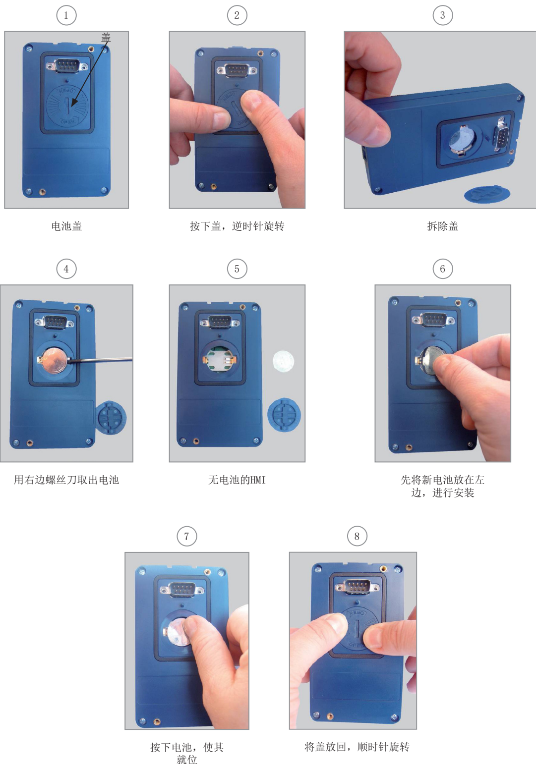
图4.4: 更换HMI电池
