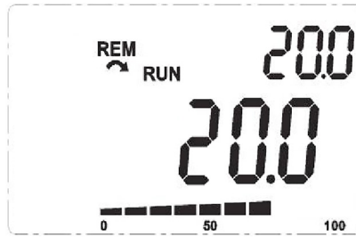
图16.3: 监控模式下使用PID控制器的HMI示例
