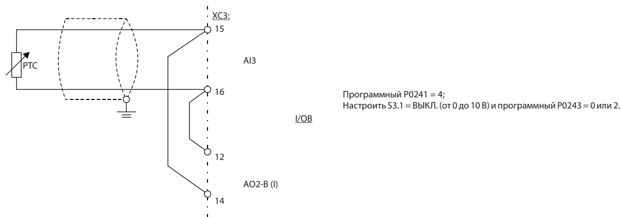
Рис. 15.1 (d). Примеры подключения PTC (продолж.)
