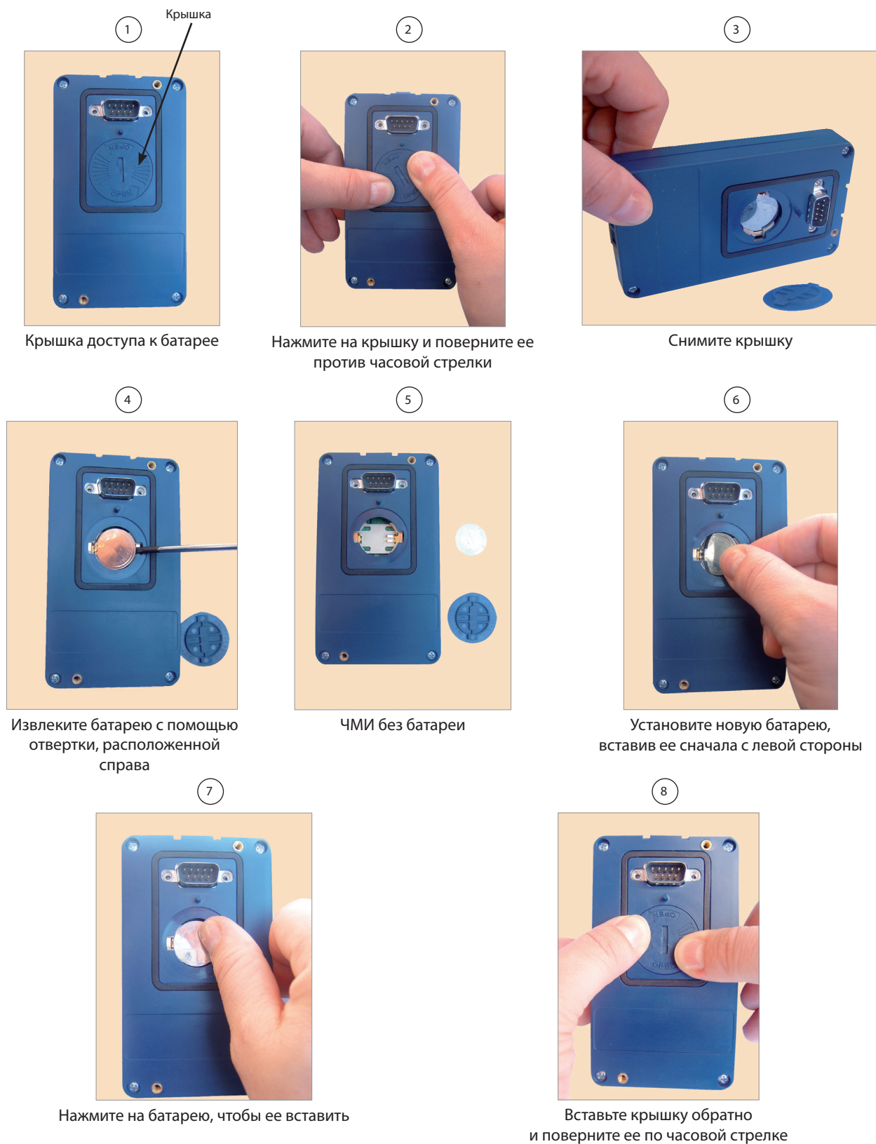
Рис. 4.2. Замена батареи ЧМИ
