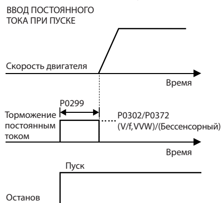
Рис. 12.10. Использование торможения постоянным током при пуске
