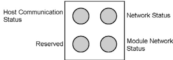
Figura 4: Indicación de los LEDs de status de la tarjeta de comunicación
