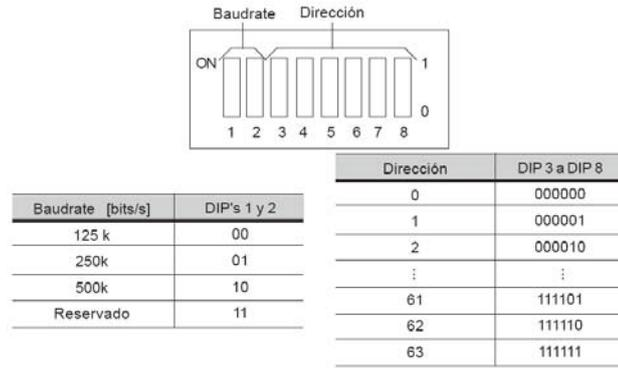
Figura 3: Configuración de la dirección y tasa de transmisión
