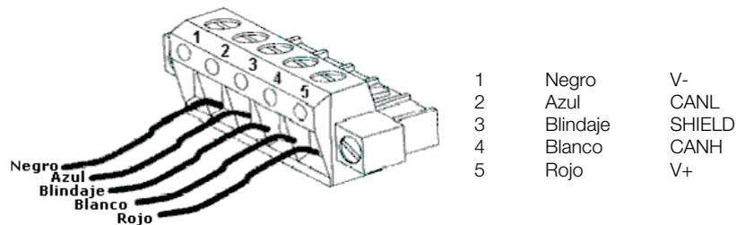
Figura 2: Conector para la red DeviceNet
