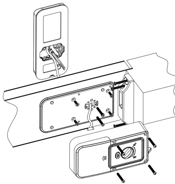
Meça a distância do furo central da porta onde a fechadura será instalada. A fechadura possui três distâncias diferentes, sendo a distância de 60 mm utilizada como padrão. Para realizar a substituição, siga o passo a passo:
