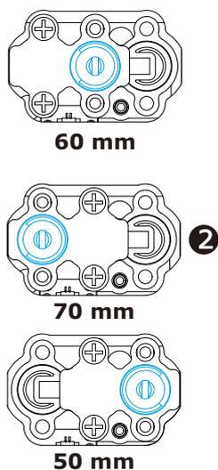
Passo 2: Movimento o cilindro para a posição desejada e aperte os parafusos.
