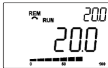
Figura 19.21: Esempio di HMI in modalità di monitoraggio per la funzione Controller PID2
