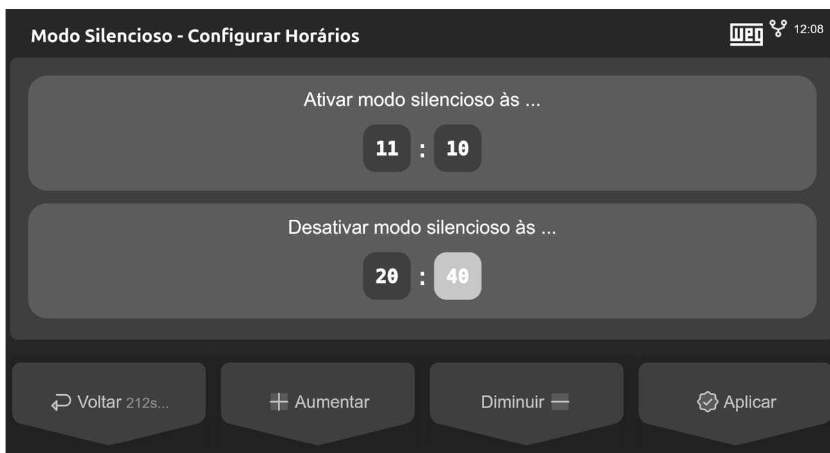
Figura 8.20: Tela final com opção "Aplicar" horários para o modo silencioso
