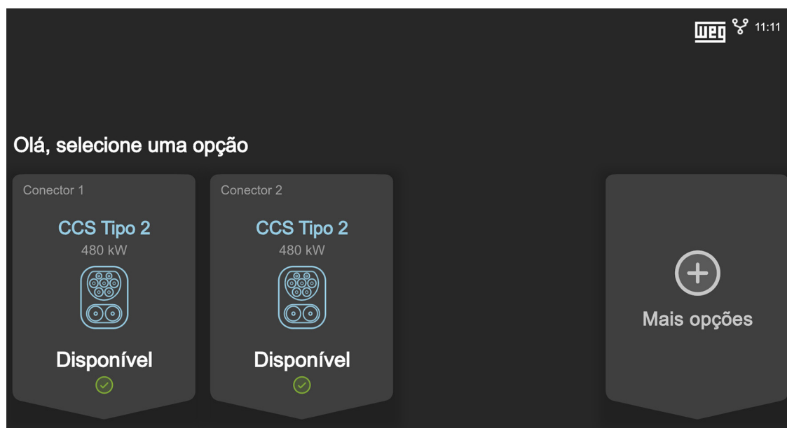
Figura 8.3: Tela inicial mostrando o status de cada um dos conectores
