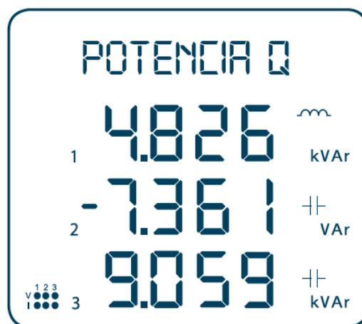
Figura 3.1: Menús de medición instantánea (potencia reactiva)
