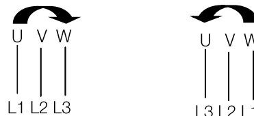
Figura 6.1: Sequência de fases (IEC60034-8)
