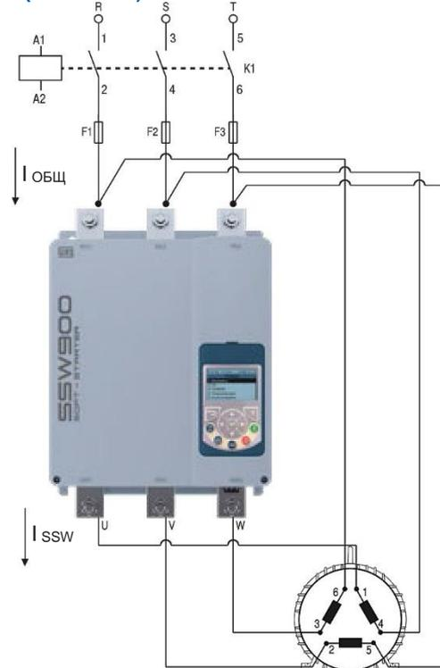
$$I_{\text{пускат.}} = \frac{I_{\text{номин.}}}{\sqrt{3}} = 58\% \text{ от } I_{\text{номин.}} \text{ (после запуска)}$$
