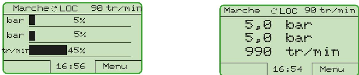
Figure 22.4: Exemple de clavier (IHM) en mode surveillance pour la fonction Régulateur PID
