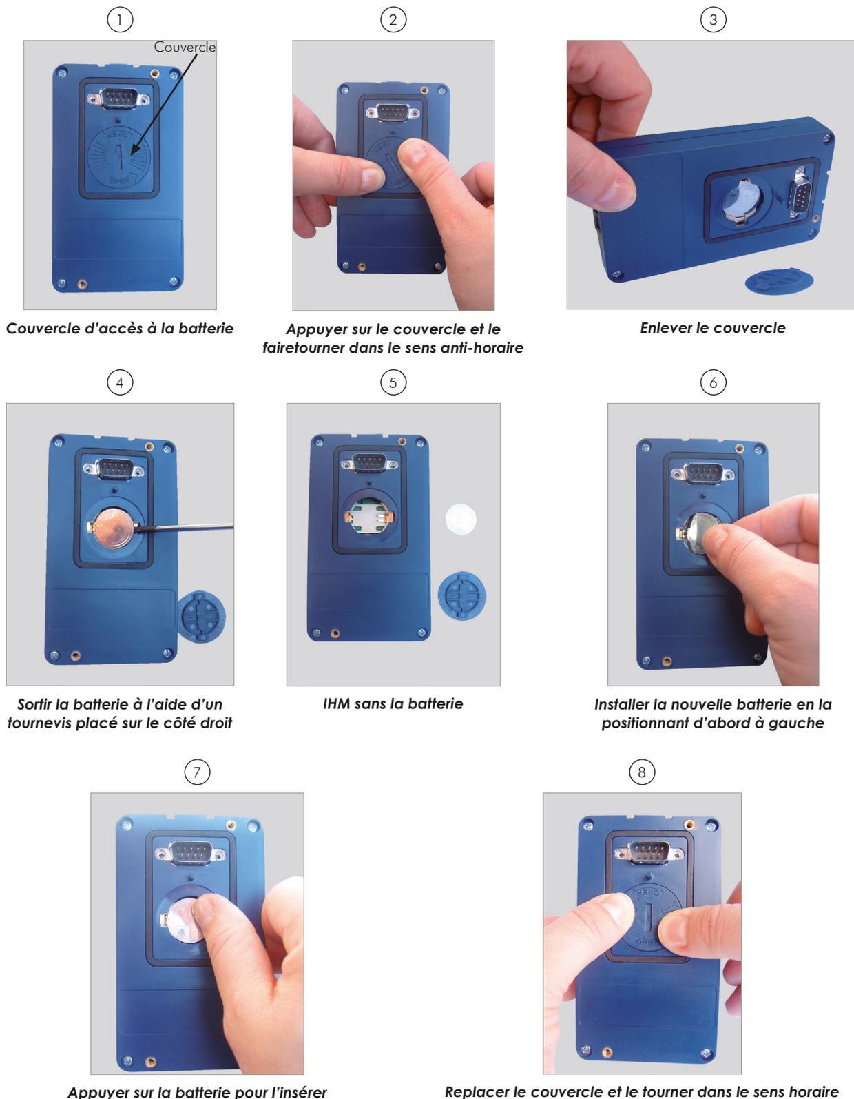
Figure 4.2: Remplacement de la batterie de l'IHM
