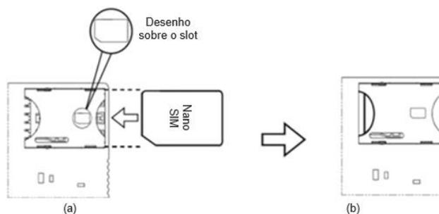
Figura 24: Procedimento para inserir o SIM Card
