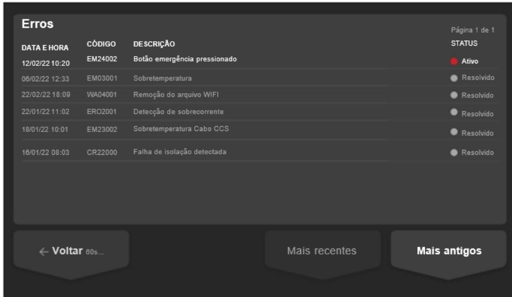
Figura 48: Tela com detalhes dos erros
