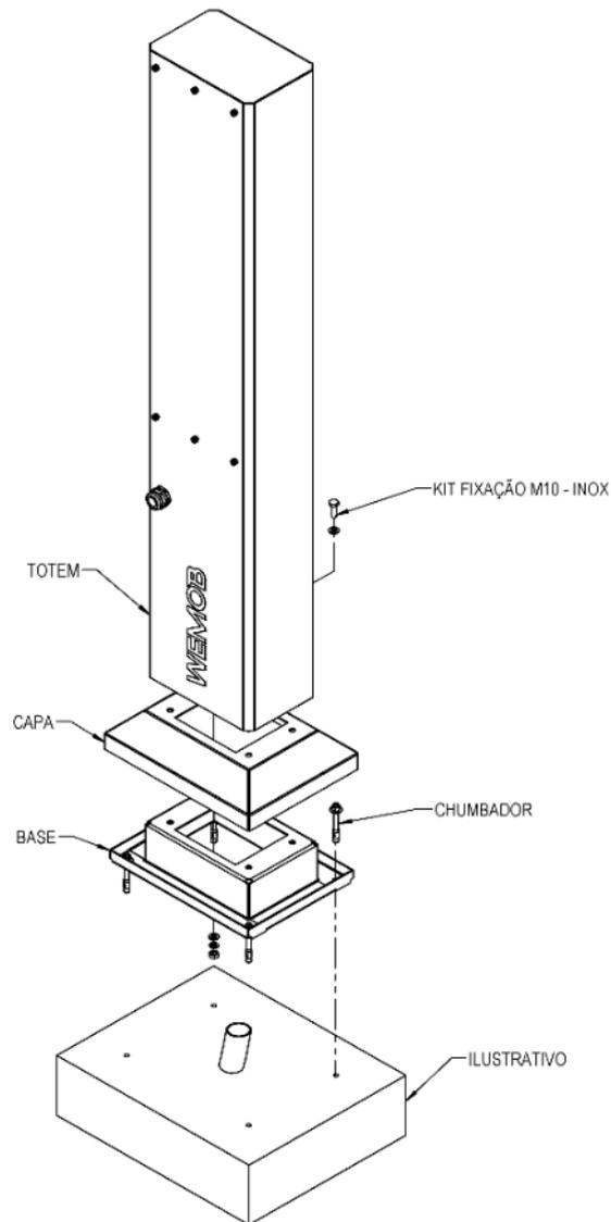
Figura 13: Detalhe fixação TOTEM
