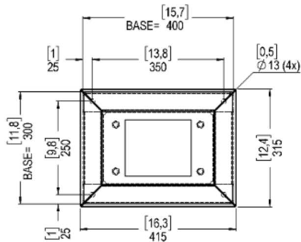
Figura 12: Detalhe base TOTEM em mm e polegadas - mm[ “ ]
