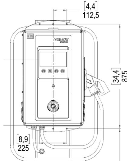
Figura 9: Distância entre furações de fixação em mm e polegadas - mm[ " ]
