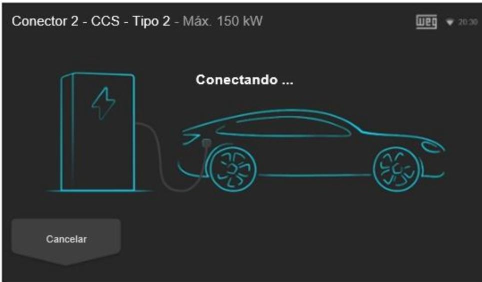
Figura 31: Tela indicando que o veículo elétrico foi conectado e está em processo de reconhecimento
