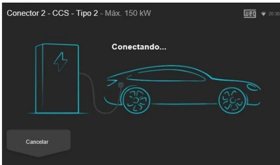
Figura 40: Tela indicando que o veículo elétrico foi conectado e está em processo de reconhecimento
