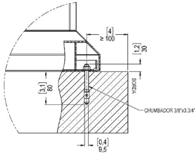
Figura 11: Detalhe chumbador TOTEM em mm e polegadas - mm[ “ ]
