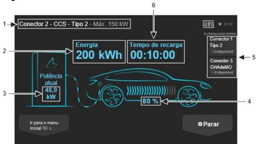
Figura 44: Tela com detalhes da recarga em andamento (exemplo 150 kW)
