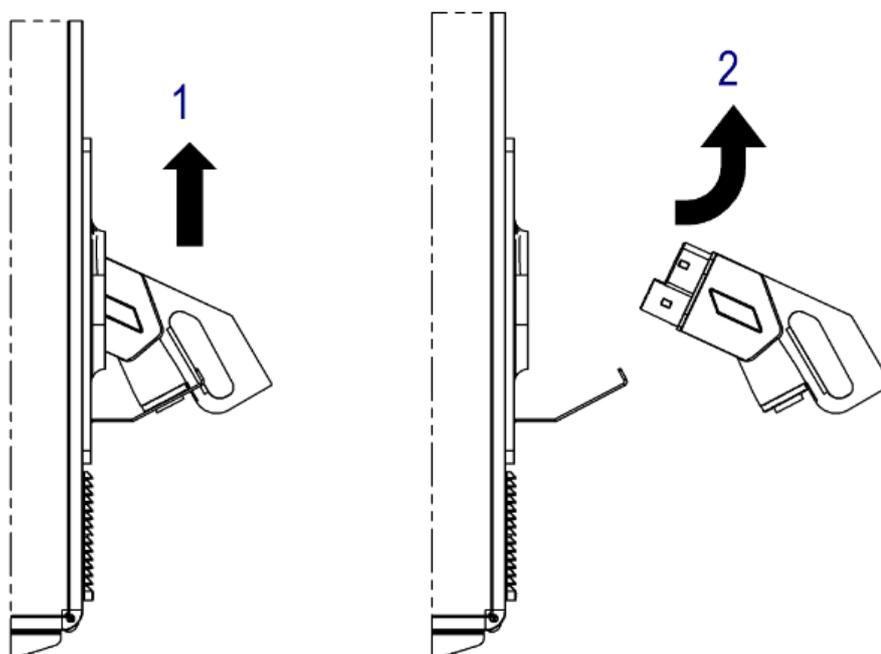
Figura 4: Procedimento para retirada do conector (plugue) do berço
