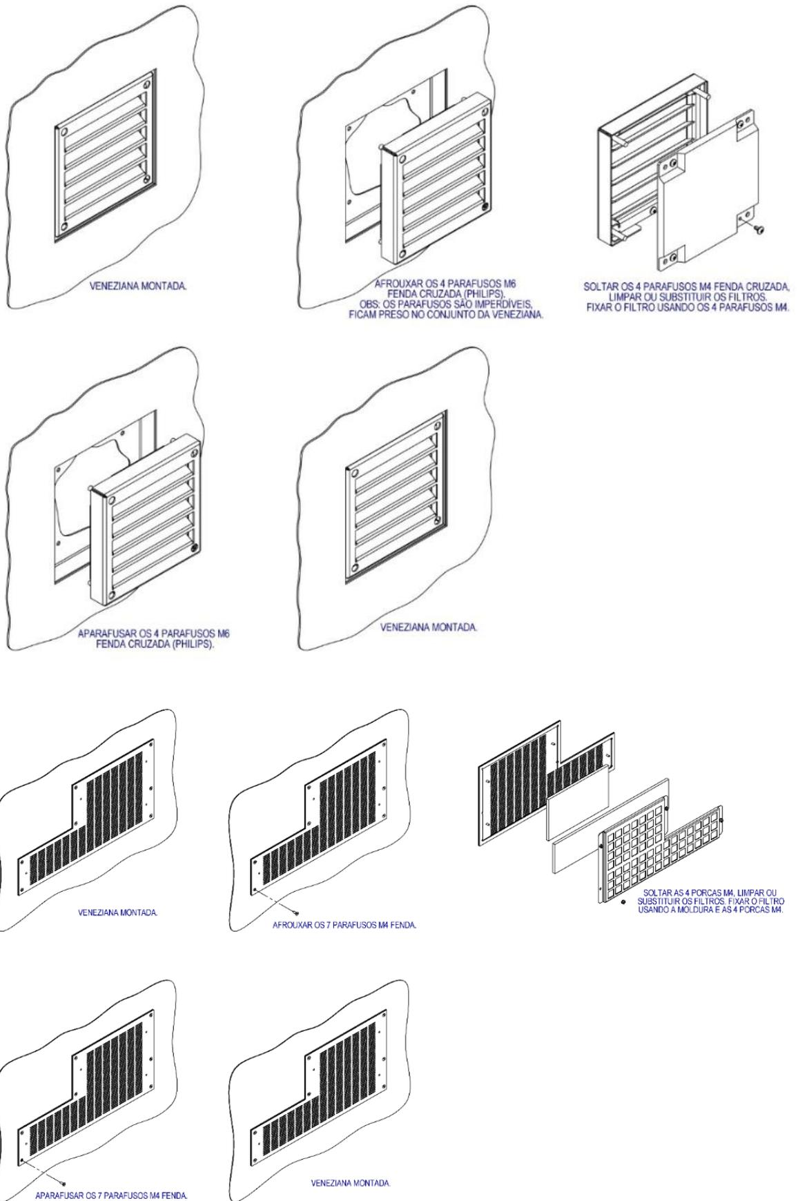
Figura 7: Substituição dos filtros de ar
