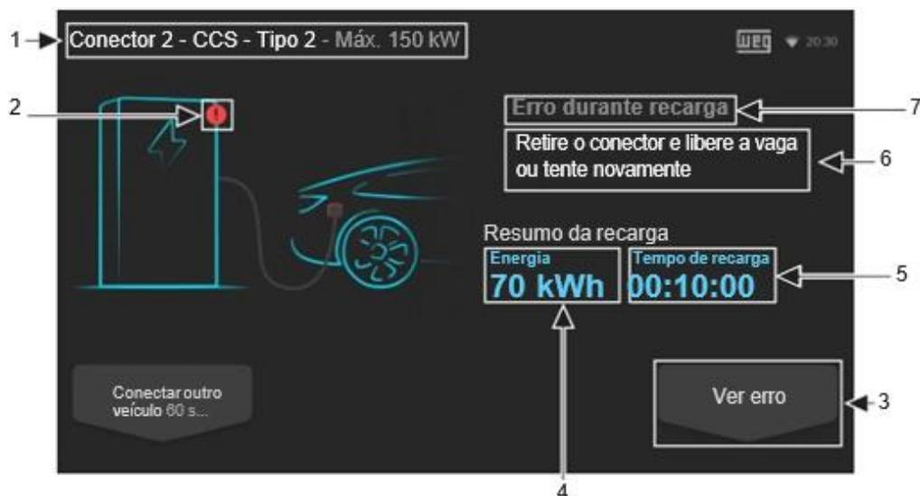
Figura 46: Tela com detalhes de uma recarga interrompida devido a um erro
