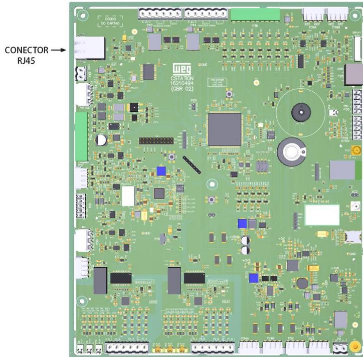
Figura 22: Localização do conector RJ45 no cartão eletrônico de controle
