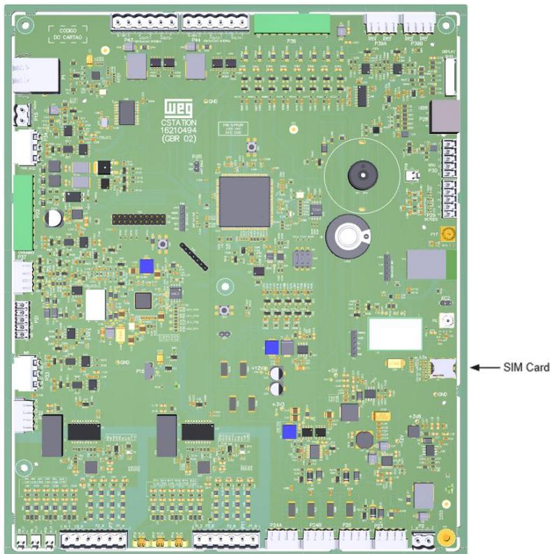
Figura 23: Localização do slot do SIM Card no cartão eletrônico de controle
