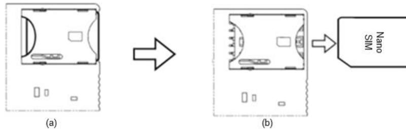
Figura 25: Procedimento para retirar o SIM Card
