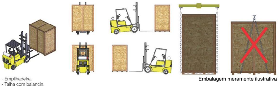
Figura 6: Procedimento para movimentação com empilhadeira ou talha
