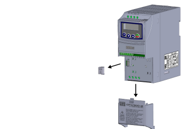
(a) Removal of the accessory and connection protection covers (XC4) from the IO expansion (a) Remoción de las tapas de accesorios y de protección de la conexión (XC4) de la expansión de IO's (a) Remoção das tampas de acessórios e de proteção da conexão (XC4) da expansão de IO's
