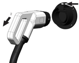
Figura 5.5: Procedimento para retirada do plugue do soquete
