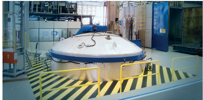
Sistema para impregnação sob vácuo e pressão
