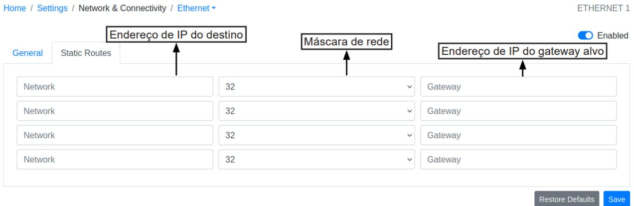
**Figura 4.17:** Tela de configuração de rotas de conexão
