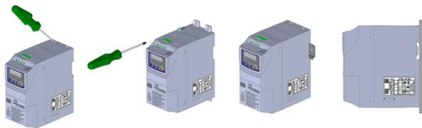
(a) Montaje en superficie (b) Montaje en riel DIN
