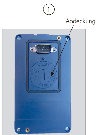
Deckel für Batterie-Zugang
