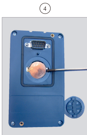
Zum Entfernen der Batterie einen Schraubenzieher an der rechten Seite ansetzen
