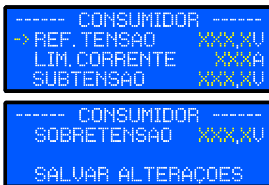
Figura 6.28: Menu de ajuste dos parâmetros do consumidor
