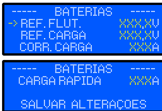
Figura 6.30: Menu de ajuste dos parâmetros do carregador de bateria
