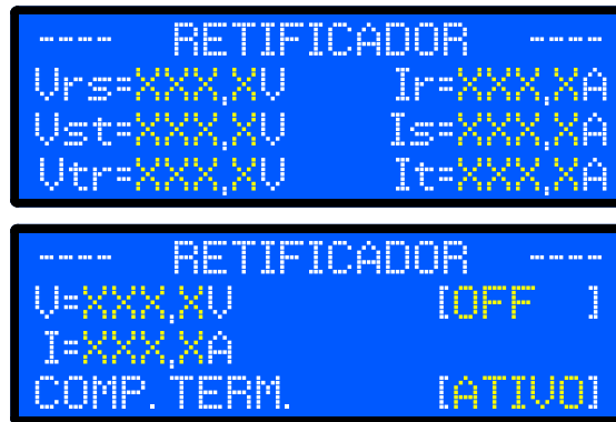
Figura 6.18: Menu de medidas do retificador
