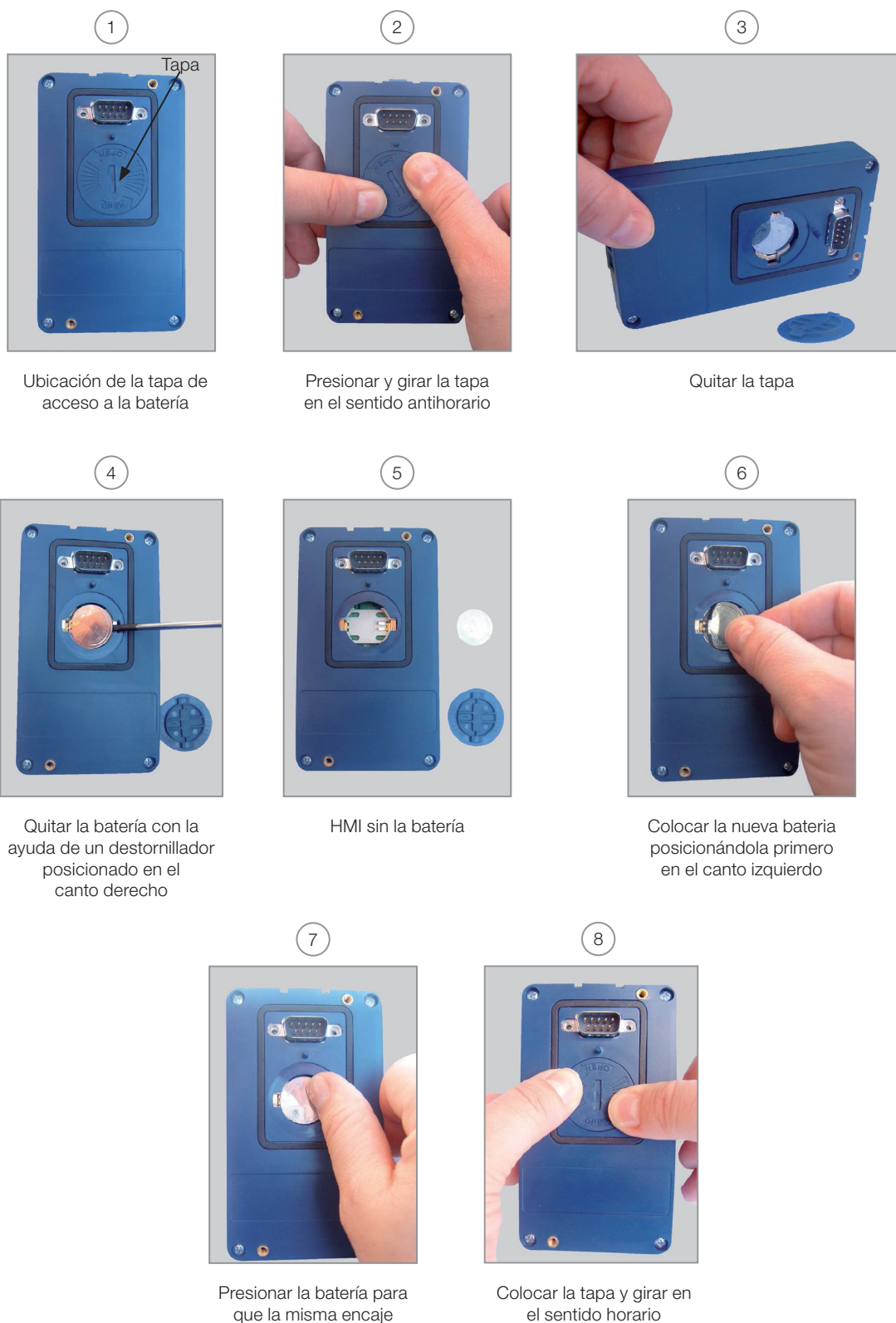
Figura 4.4: Sustitución de la batería de la HMI
