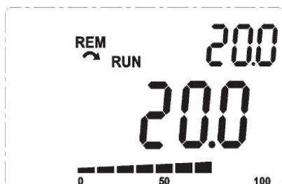
Figura 16.3: Ejemplo de la HMI en modo monitoreo para la utilización del regulador PID
