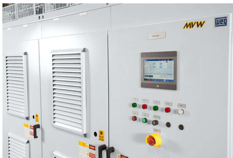
Figura 4.1: HMI para el convertidor MVW01
