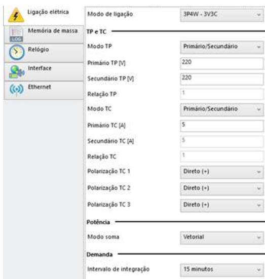
Figura 1.9: Menu de configurações de ligações elétricas
