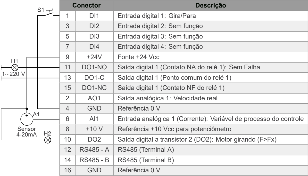
Figura 4.2: Sinais no conector do módulo plug-in CFW500-IO5 para setpoint do controle via HMI
