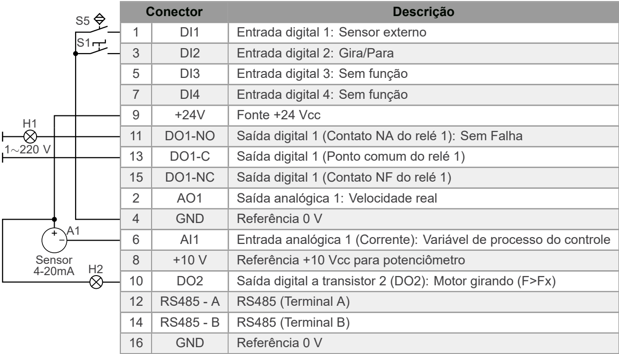
Figura 4.10: Sinais no conector do módulo plug-in CFW500-IOS para proteção da bomba com sensor externo via entrada digital DI1
