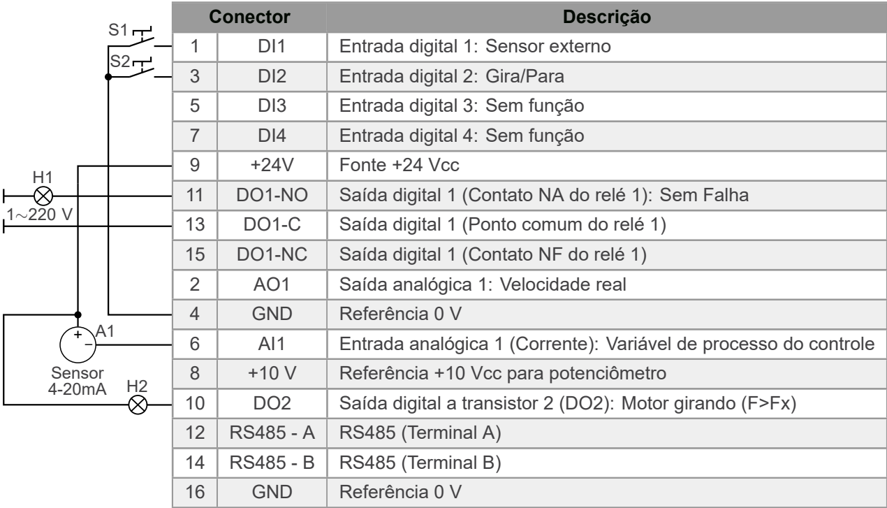
Figura 4.14: Sinais no conector do módulo plug-in CFW500-IOS para desentupimento da bomba com comando via entrada digital DI2
