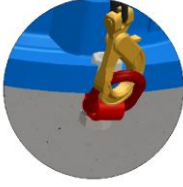
Şəkil 4-3 – Qabırğalı soyudulan mühərrikin yüklənmə-boşaltmasında istifadə edilən əlavə halqalı bolt detallı (mühərriklə birgə təmin edilmir)
