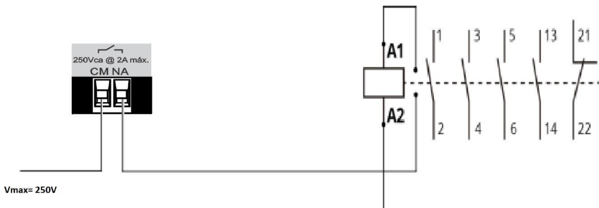
Figura 14 - Esquema de ligação Saída Digital
