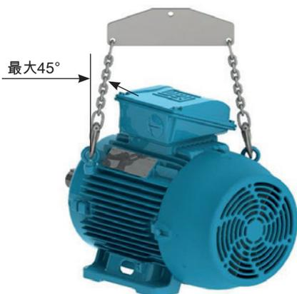
图4.4 - 带有两个或多个吊环螺栓的电动机的最大合力角
