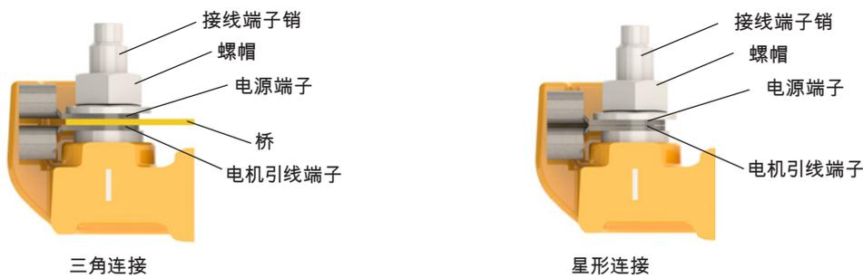
图6.13 - 带接线端子的W21和W22电机的连接
