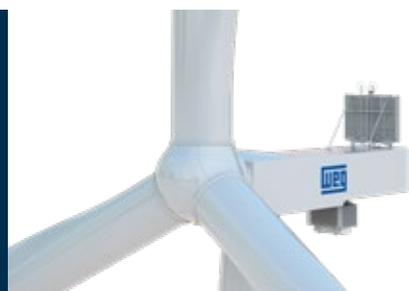
O aerogerador AGW172/7.0 é uma evolução do portfólio da WEG, possui potência nominal de 7 MW e rotor com diâmetro de 172 metros, oferecendo a melhor produção de energia da categoria. Esta plataforma utiliza a caixa de engrenagens multiplicadora de média rotação e tem como vantagens a conexão suave e controlada na rede, a pré-montagem no local com guindastes menores, um tempo de instalação reduzido, entre outras.
