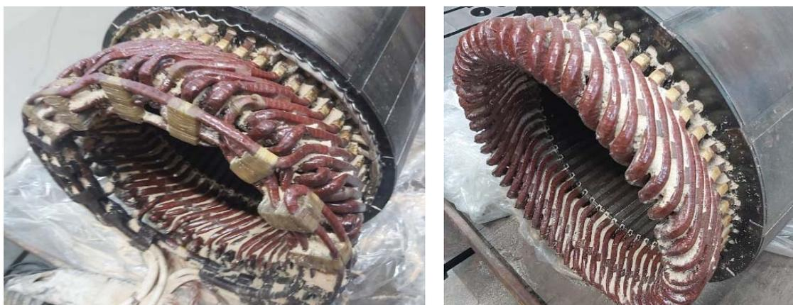
Figura 13: Amostra contaminada com serragem fina umedecida (Fonte: WEG)
