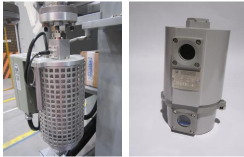
Figura 23 - Modelos de desumidificadores de ar a sílica gel
