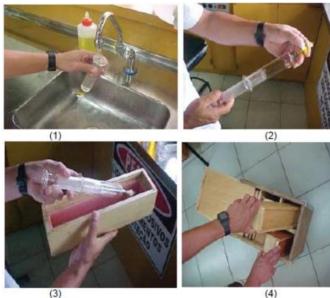
Figura 47 - Limpeza da seringa (1 e 2) e armazenamento (3 e 4)
