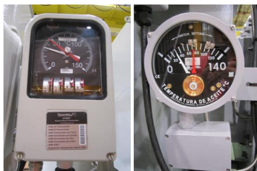
Figura 28 - Termômetros com bulbo com capilar e contatos tipo microswitch
