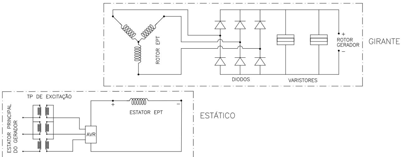
Figura 5.2: Circuitos elétricos internos do gerador sem PMG
