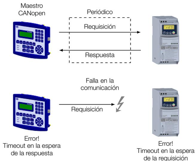
Para el servicio de Node Guarding, existen dos objetos del diccionario para configuración de los tiempos para detección de errores de comunicación:
