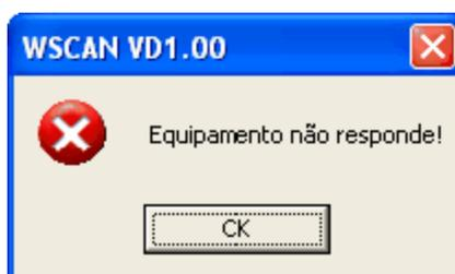
Neste caso é necessário verificar a correta conexão do cabo serial entre a porta serial do computador e o conector serial do cartão, também é necessário verificar a configuração serial utilizada pelo software WSCAN e a configuração setada no cartão em questão.
