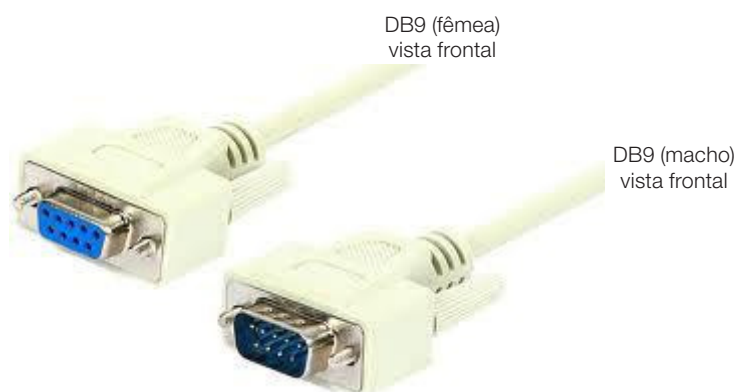
Figura 3.22: Identificação visual dos conectores DB9 (macho e fêmea)
