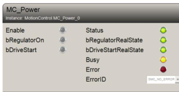
*Figura 3.9: Ejemplo de servomotor habilitado.*
