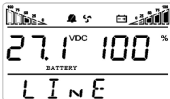
Figura 6.8: Display frontal do Studio com os dados relacionados a bateria do produto
