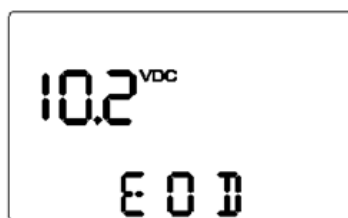
Figura 5.10: Configuração da tensão mínima das baterias do Studio
