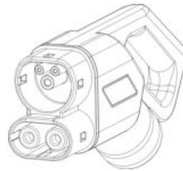
Figura 3: Modelo do conector da WEMOB-STATION CCS-2
