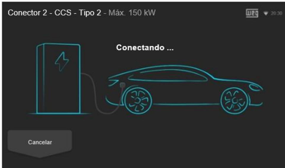
Figura 29: Tela indicando que o veículo elétrico foi conectado e está em processo de reconhecimento
