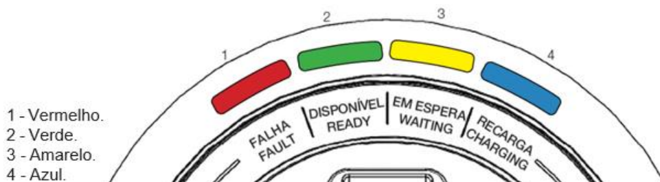
Figura 5: Leds de sinalização
