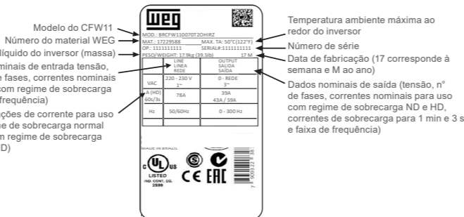
(b) Etiqueta de identificação sob a HMI
