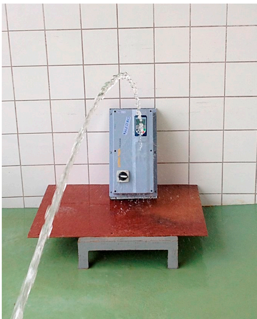
Testes com jato de água
