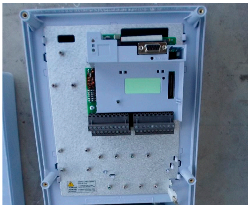
Lado interno da amostra 01 após 8 horas do teste de pó; placas de controle
