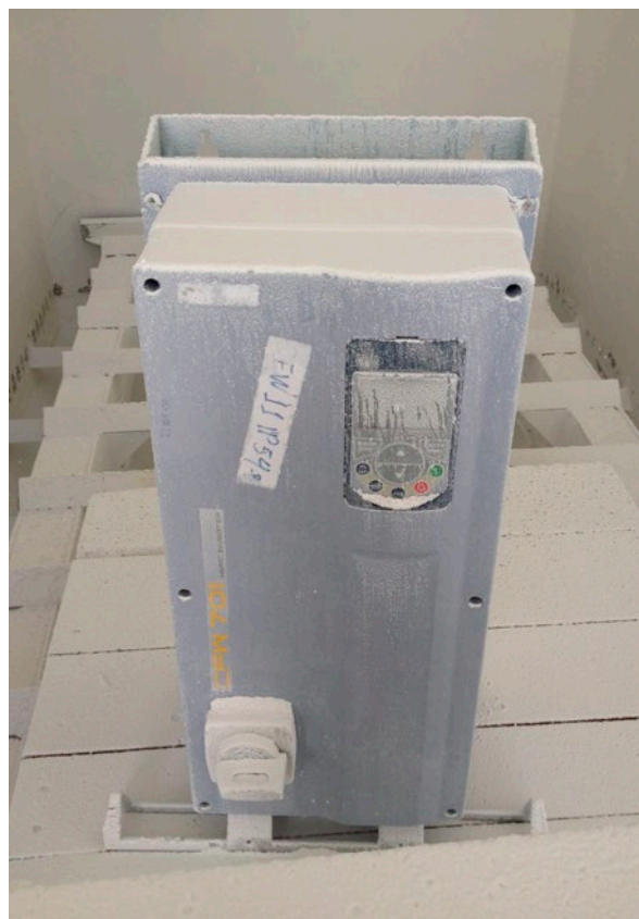
Teste com calibrador e câmara de poeira
