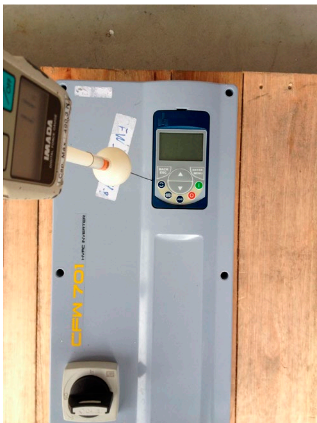
Teste com calibrador e câmara de poeira
