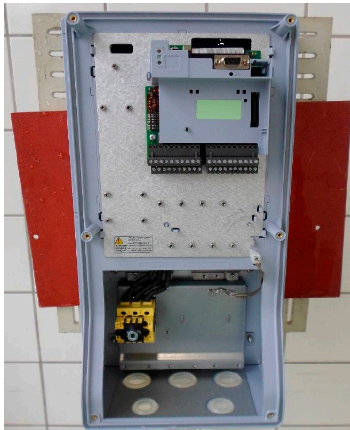
Lado interno da amostra 01 após o teste de entrada de água; placa de controle e entrada
