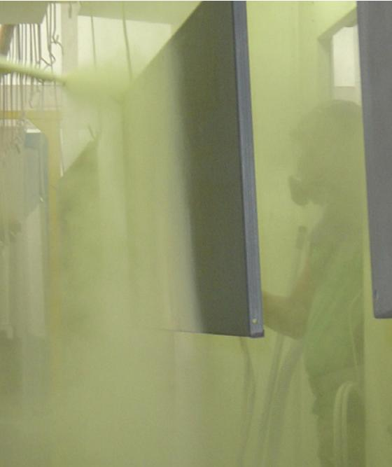
Las tintas en polvo de baja cura son indicadas para la aplicación en materiales donde no es posible la cura en el tiempo especificado para las tintas en polvo convencionales. Debido a la característica de sustrato o las particularidades en el proceso de producción como por ejemplo:
