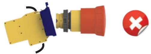
Brida NO montada correctamente en el botón.
