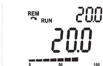
Rysunek 16.3: Przykład interfejsu HMI w trybie monitorowania do korzystania z regulatora PID
