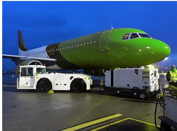
**Figura 2:** Aeronave alimentada eléctricamente por un GPU
