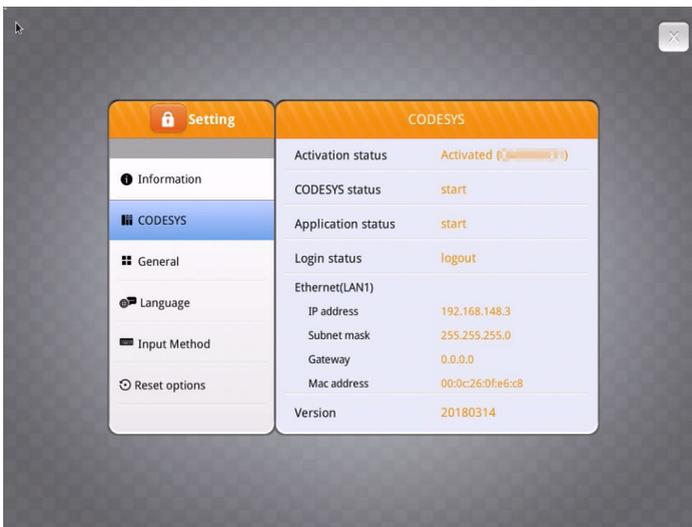
**Step 13:** Abra el servidor web de la IHM; usted también puede verificar la guía CODESYS. Ahora usted puede actualizar el proyecto y el firmware del CODESYS.
