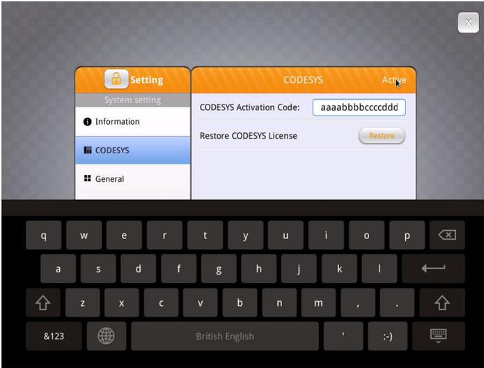
**Step 10:** Si la activación fue correcta, usted verá el mensaje "Please put on license sticker on the back of HMI and then reboot HMI" ("Pegue el adhesivo de licencia en la parte de atrás de la IHM y reiniciela"). Si usted tuvo algún problema, consulte la última sección "Códigos de Error de Activación".
