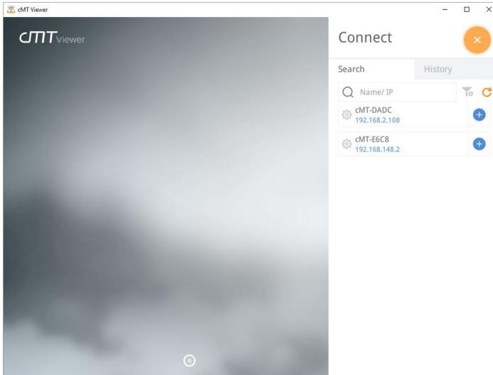
**Step 6:** Abra o navegador da web e digite o endereço IP da IHM. Por exemplo, o endereço IP da IHM é 192.168.0.211. Digite “http://192.168.0.211” na barra de endereço e pressione Enter. Se você usar o cMT Viewer, pode clicar no ícone de configuração.
