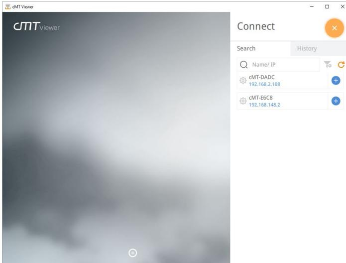
**Step 6:** Abra el navegador de la web y digite la dirección IP de la IHM. Por ejemplo, la dirección IP de la IHM es 192.168.0.211. Digite “http://192.168.0.211” en la barra de dirección y presione Enter. Si usted usa el cMT Viewer puede hacer clic en el ícono de configuración.
