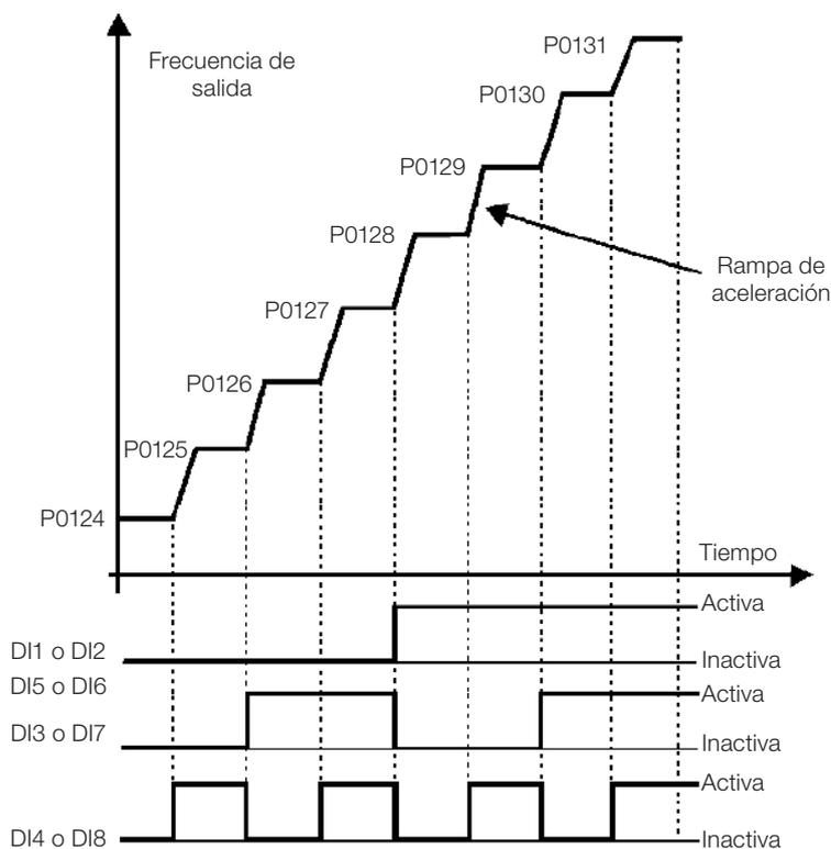
**Figura 7.4:** Gráfico de funcionamiento de la función Multispeed
