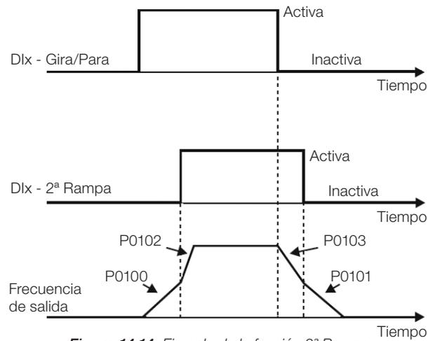
Figura 14.14: Ejemplo de la función 2ª Rampa
