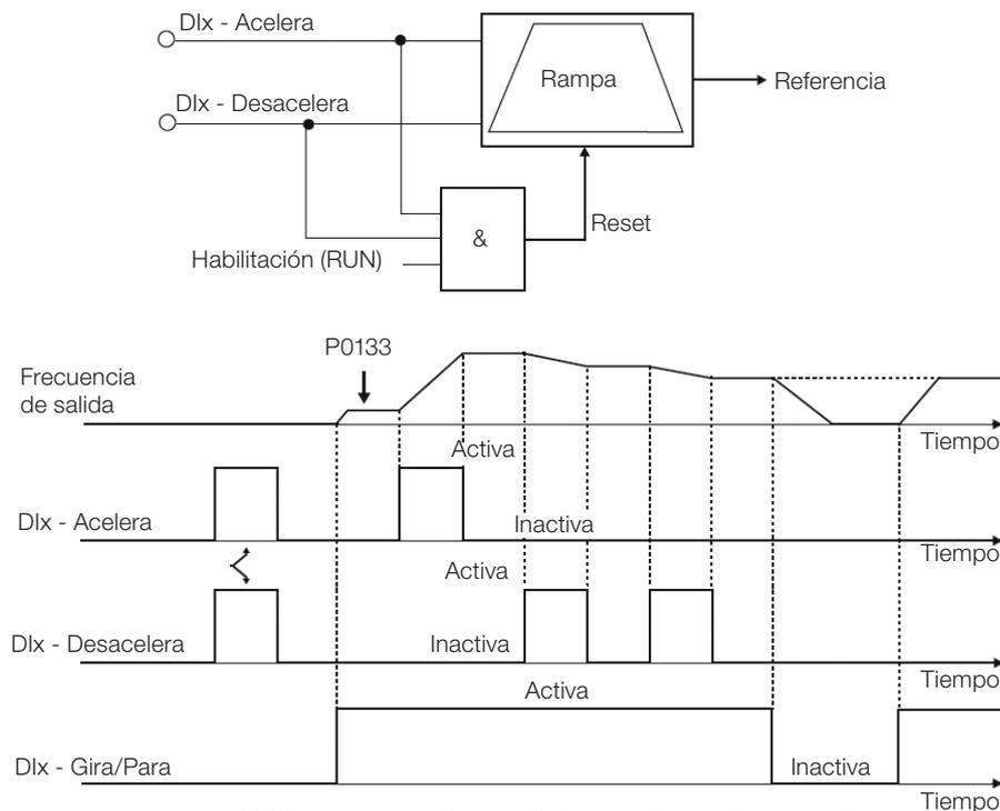
**Figura 14.13:** Ejemplo de la función Potenciómetro Electrónico (E.P.)
