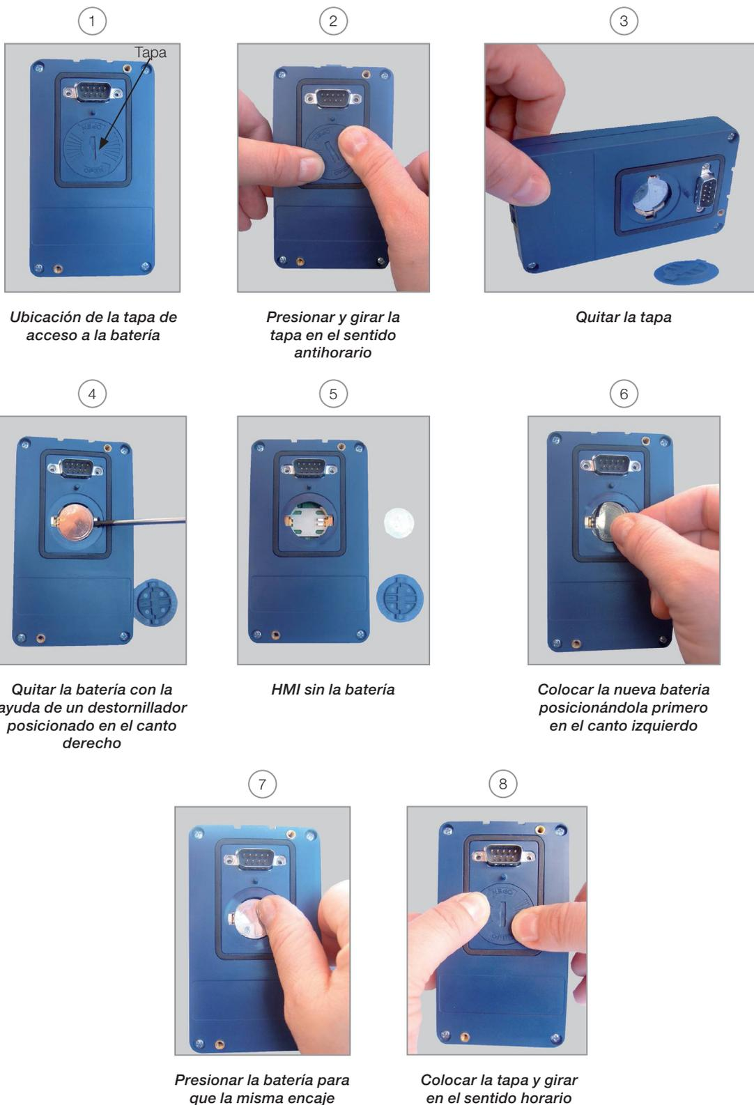
Figura 4.4: Sustitución de la batería de la HMI
