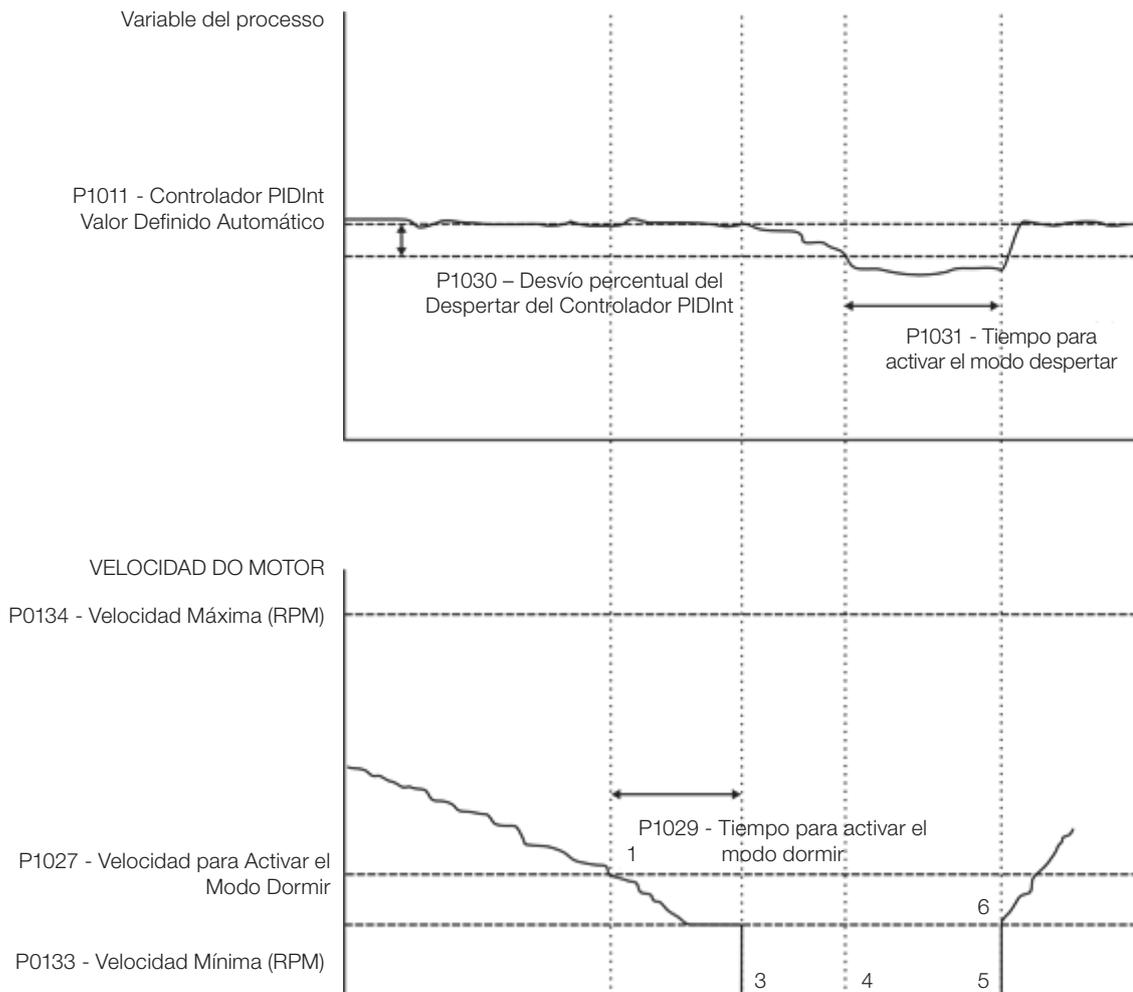
**Figura 20.1:** Esquema de funcionamiento para modo dormir y modo despertar
