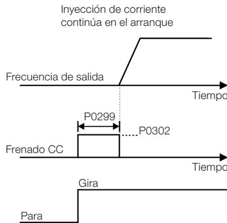
Figura 13.6: Actuación del Frenado CC en el arranque
