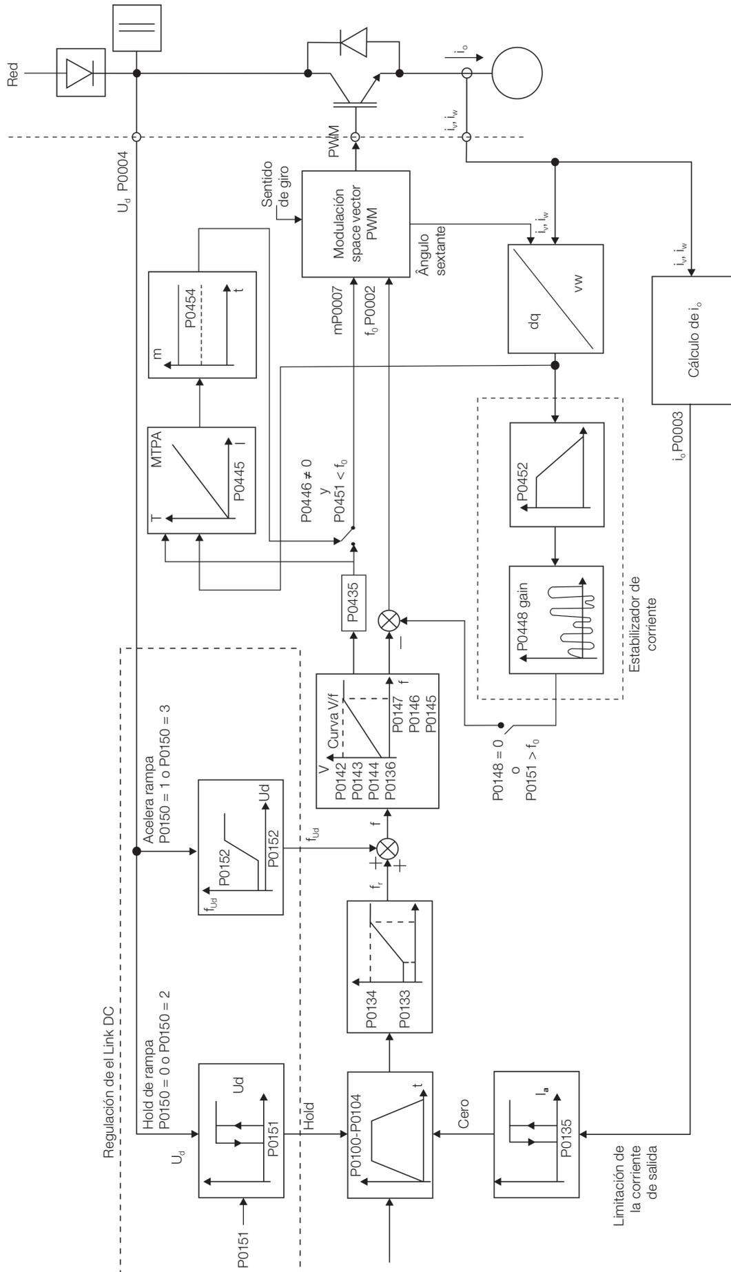
Figura 11.1: Diagrama de bloques del control VVW PM
