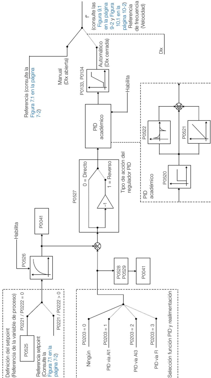
Figura 15.1: Diagrama de bloques del regulador PID
