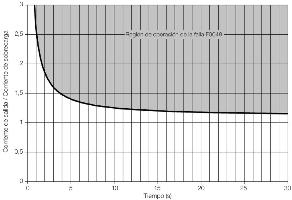
**Figura 17.3:** Actuación de la sobrecarga de los IGBTs (Normal Duty - ND)
