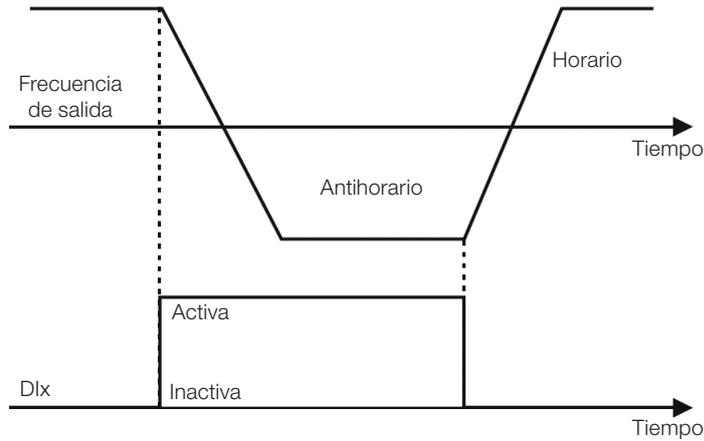
Figura 14.11: Ejemplo de la función Sentido de Giro
