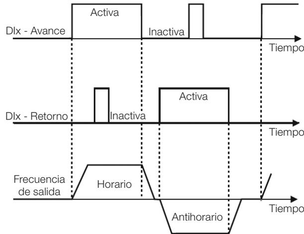
Figura 14.9: Ejemplo de la función Avance / Retorno
