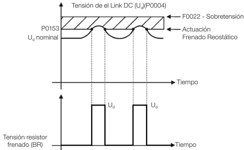
Figura 16.1: Curva de actuación del Frenado Reostático
