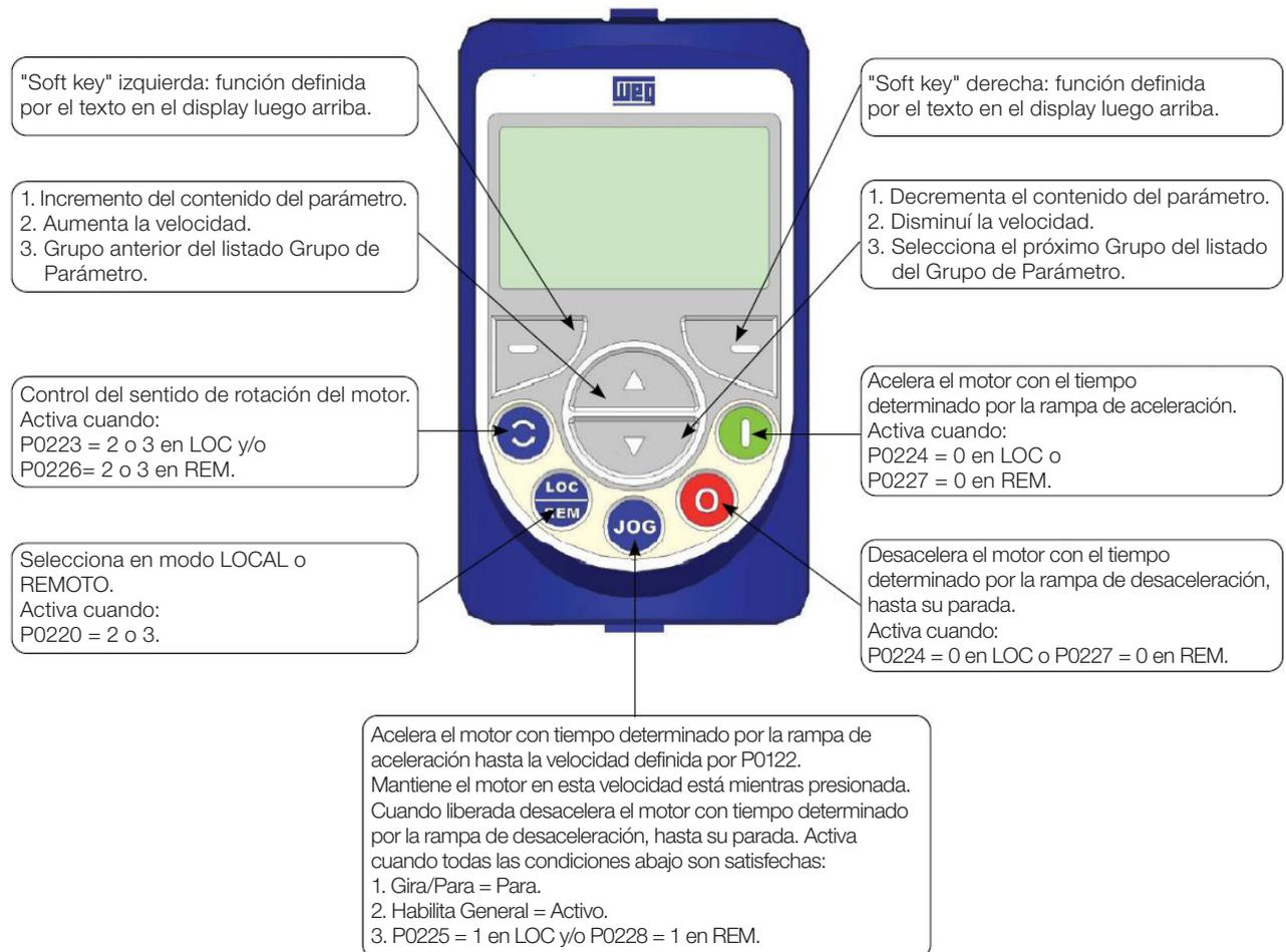
**Figura 4.3:** Teclas de la HMI
