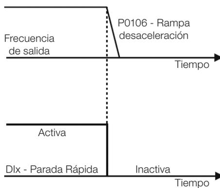
Figura 14.8: Ejemplo de la función Parada Rápida
