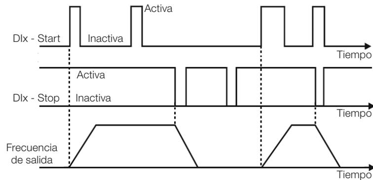
Figura 14.10: Ejemplo de la función Start / Stop tres hilos
