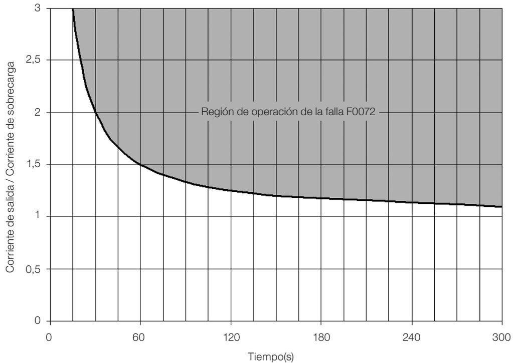
**Figura 17.1:** Actuación de la sobrecarga del motor
