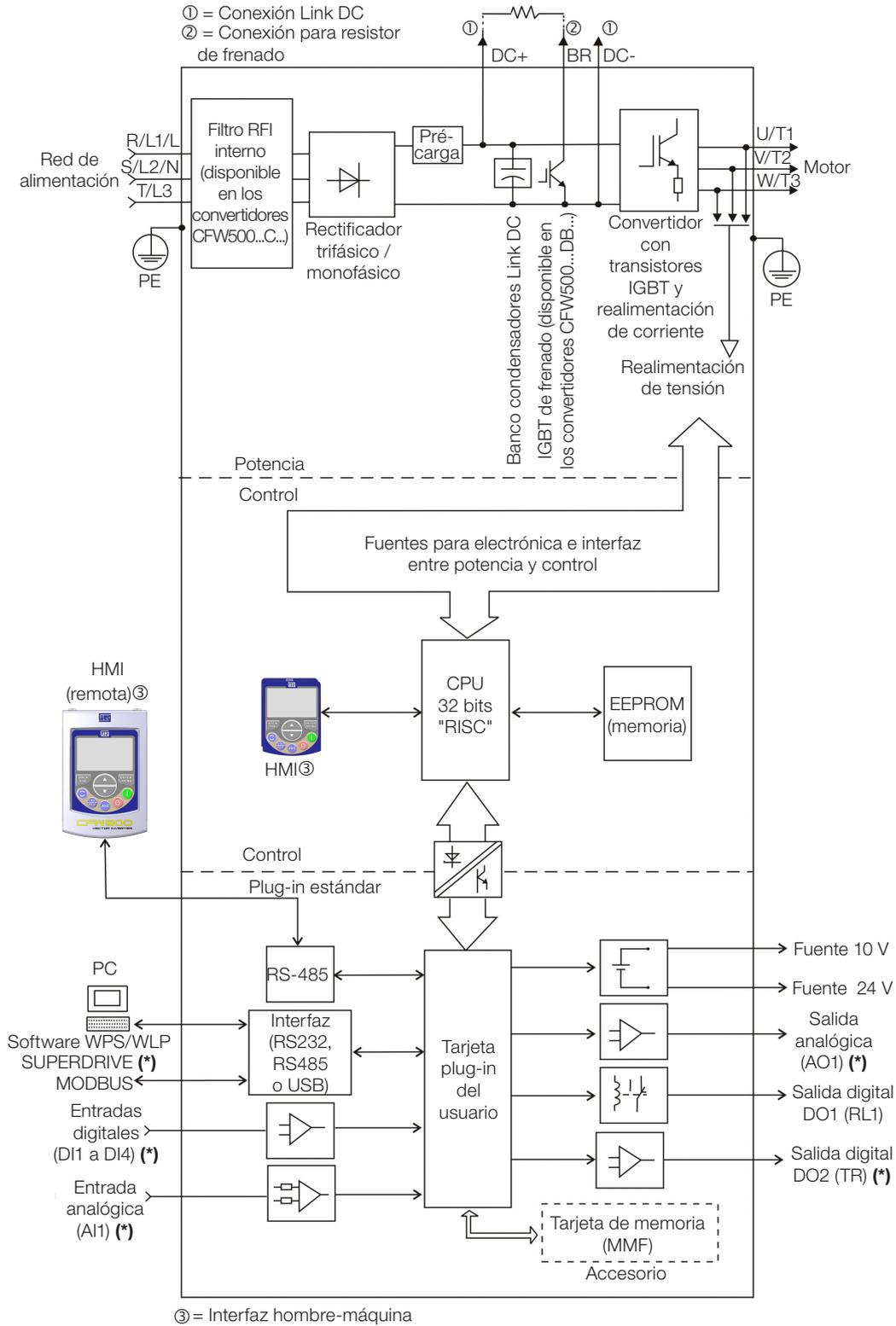
(\*) El número de entradas y salidas, analógicas y digitales puede sufrir variaciones de acuerdo con el plug-in utilizado. Para más informaciones, consulte la guía de instalación, configuración y operación del opcional con módulo plug-in utilizado.
