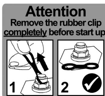
Antes da colocação em funcionamento, extraír completamente a aba de borracha!
