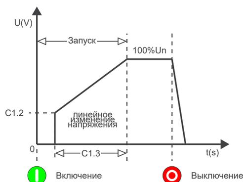
Рисунок 11.3: Линейное ускорение за счет линейного изменения напряжения
