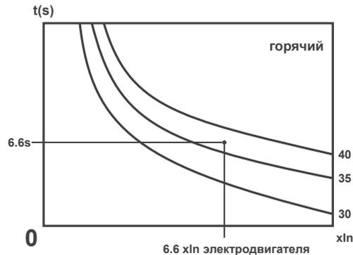
**Рисунок 13.26:** Определение максимального класса тепловой защиты по кривым горячего запуска
