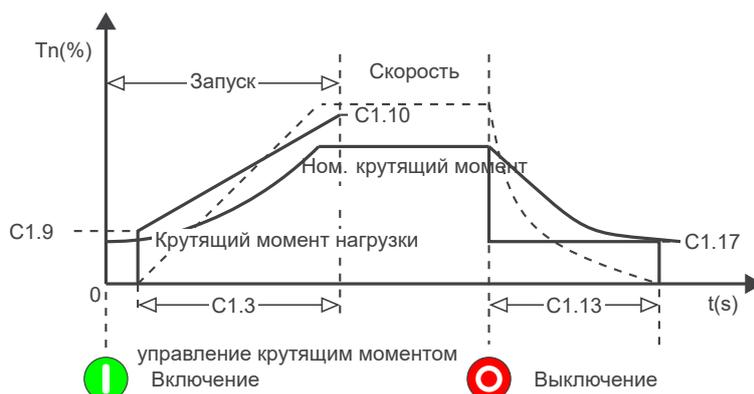
Рисунок 13.20: Остановка гидравлического насоса с постоянным крутящим моментом (1-ступенчатое регулирование)
