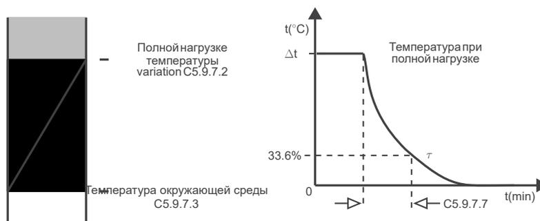
Рисунок 11.26: Константа охлаждения электродвигателя без питания
