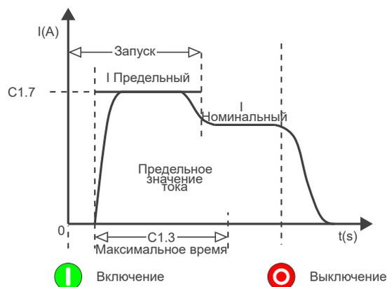
Рисунок 13.5: Запуск с предельным значением тока.
