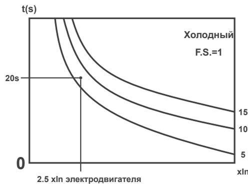
Рисунок 13.25: Определение минимального класса тепловой защиты для холодного запуска электродвигателя
