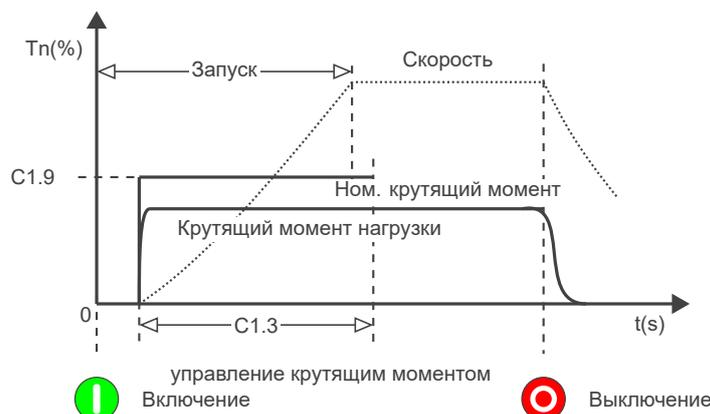
Рисунок 13.12: Запуск с постоянным управлением крутящим моментом — одноступенчатое регулирование
