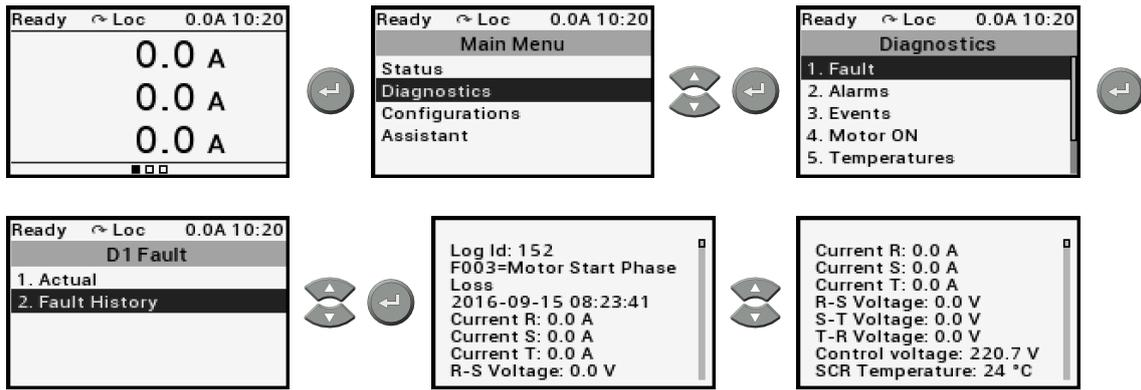
Рисунок 8.5: Считывание журнала отказов
