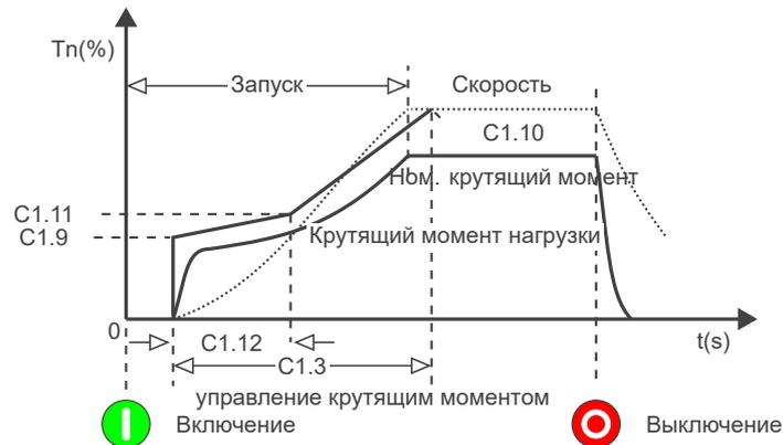
**Рисунок 13.16:** Запуск с квадратичным управлением крутящим моментом (трехступенчатое регулирование) с квадратичной нагрузкой
