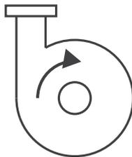
Рисунок 13.8: Направление вращения центробежного гидравлического насоса
