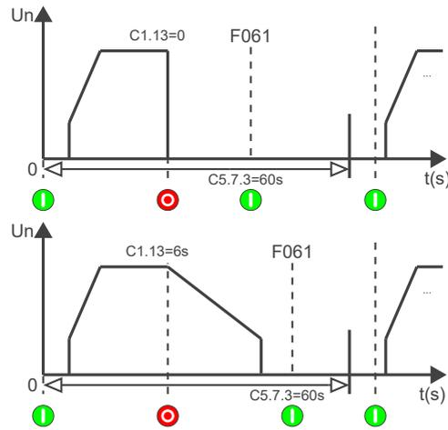
Рисунок 11.19: Интервал между запусками
