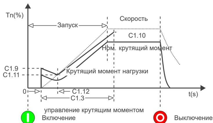
**Рисунок 13.17:** Запуск с квадратичным управлением крутящим моментом (трехступенчатое регулирование), квадратичная нагрузка с повышенным начальным крутящим моментом
