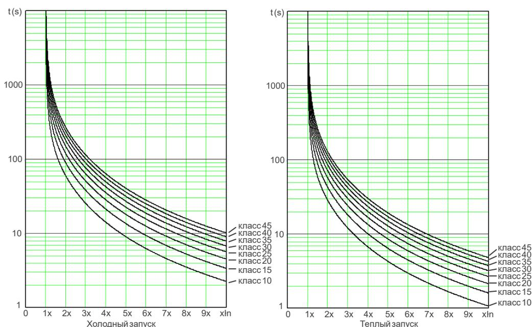
Рисунок 11.22: Стандартный класс тепловой защиты электродвигателя
