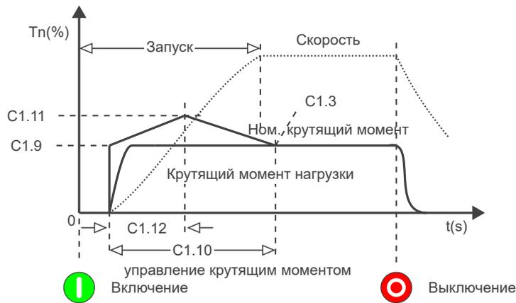
**Рисунок 13.14:** Запуск с квадратичным управлением крутящим моментом (трехступенчатое регулирование) с постоянной нагрузкой.
