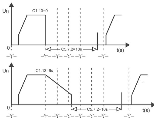
Рисунок 11.17: Пуск по трехпроводной схеме цифрового входа (DI1 и DI2)
