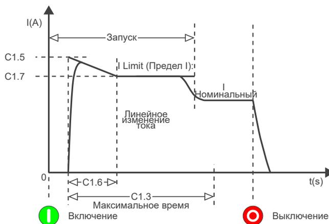
**Рисунок 11.6:** Запуск с линейным изменением тока и повышенным начальным значением.
