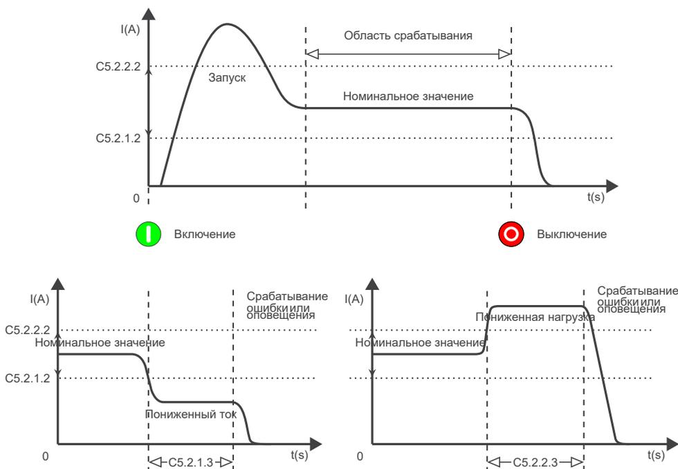
Рисунок 11.14: Уровни срабатывания при повышенном или пониженном токе
