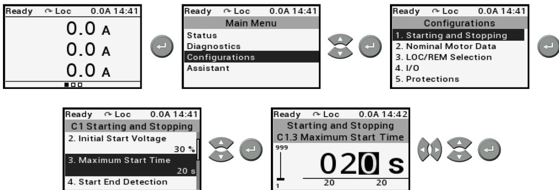
Рисунок 8.6: Программирование максимального времени пуска
