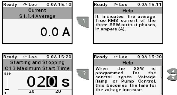
Рисунок 8.8: Пример использования программируемой клавиши справки
