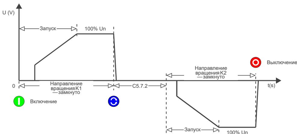
Рисунок 11.28: Смена направления вращения электродвигателя с помощью контакторов
