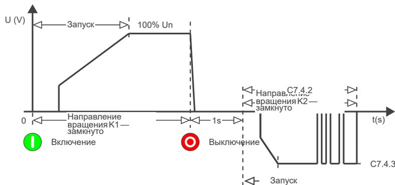
Рисунок 11.32: Торможение обратным ходом
