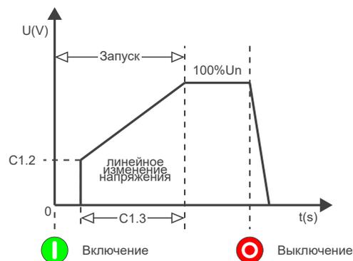
Рисунок 13.4: Запуск с линейным изменением напряжения.
