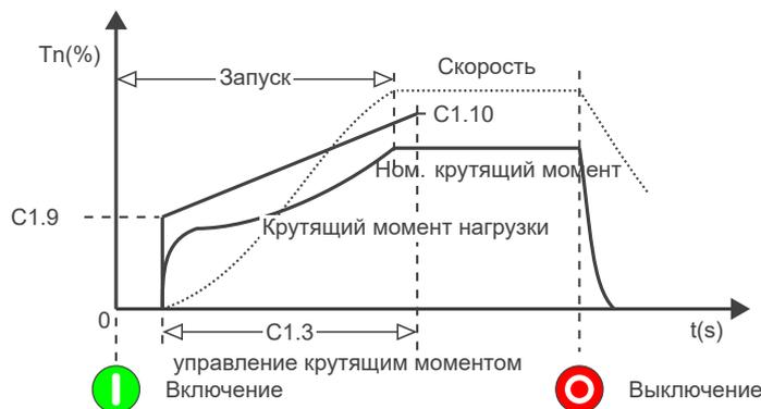
**Рисунок 13.15:** Запуск с линейным управлением крутящим моментом (2-ступенчатое регулирование) с квадратичной нагрузкой
