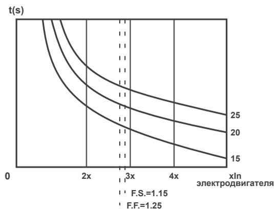
Рисунок 13.27: Использование коэффициента эксплуатации для определения нового временного интервала
