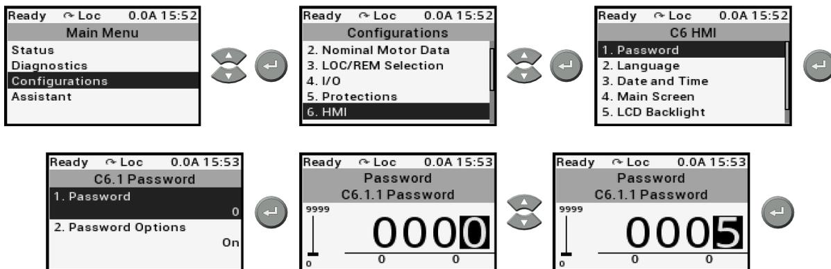
Рисунок 8.9: Пароль для разрешения изменений параметров
