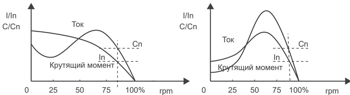
**Рисунок 13.1:** Кривые характеристик крутящего момента и тока для прямого запуска от сети и запуска с линейным изменением напряжения.
