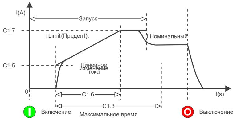
Рисунок 13.7: Запуск с линейным изменением тока и пониженным начальным значением
