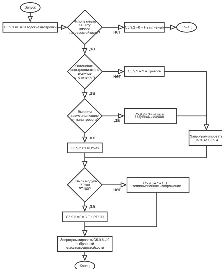
Рисунок 11.20: Последовательность программирования теплового класса защиты — стандартный режим
