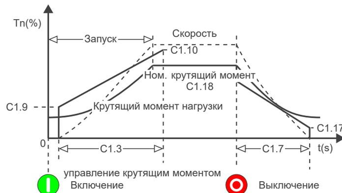
Рисунок 13.21: Остановка гидравлического насоса с линейным крутящим моментом (2-ступенчатое регулирование)
