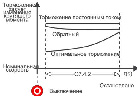
Рисунок 11.31: Торможение за счет изменения крутящего момента
