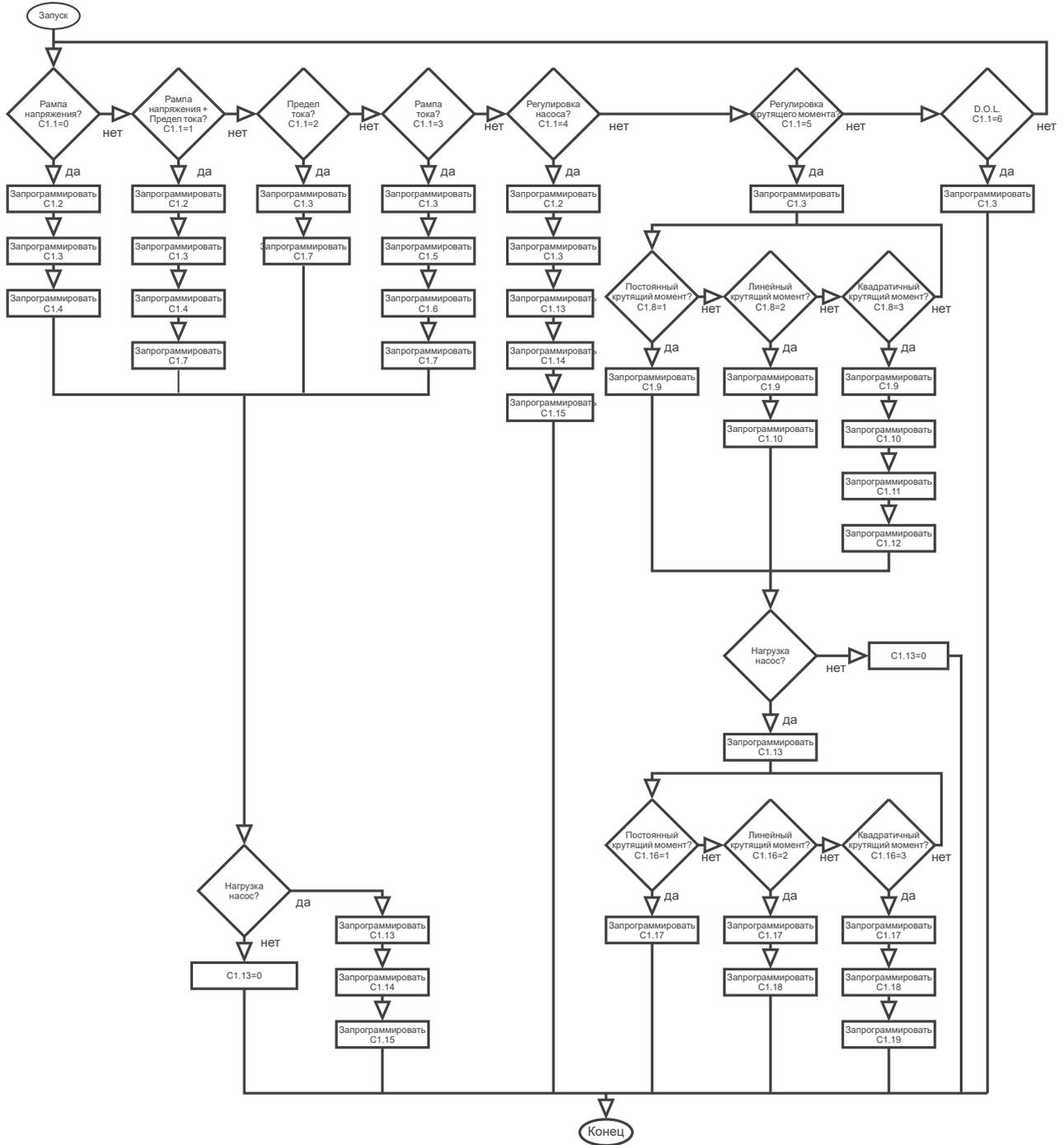
Рисунок 11.1: Последовательность программирования типа управления
