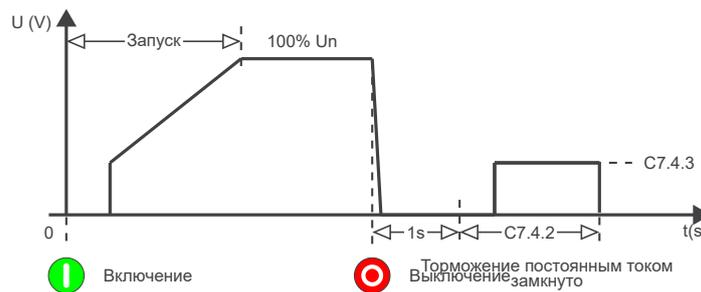
Рисунок 11.34: Торможение постоянным током
