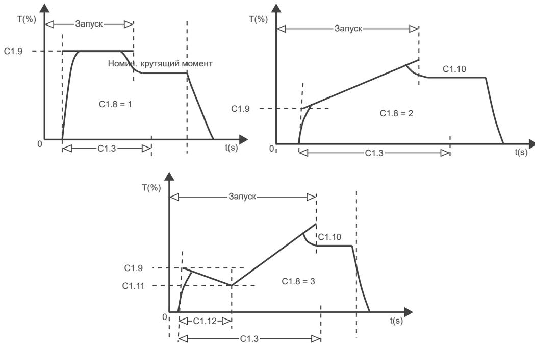
Рисунок 11.8: Доступные профили пускового крутящего момента
