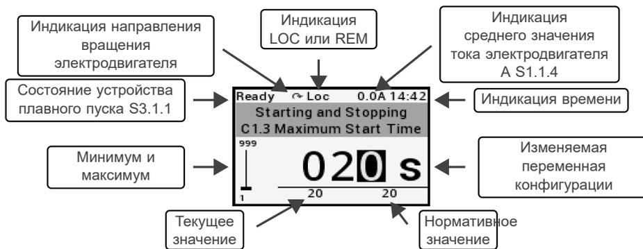
Рисунок 8.7: Данные на экране конфигурации
