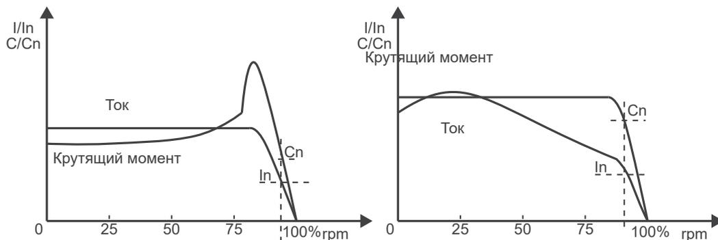
**Рисунок 13.2:** Кривые характеристик крутящего момента и тока для запуска с ограничением тока и пуска с регулированием крутящего момента.
