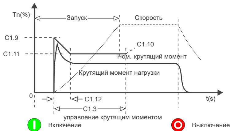
**Рисунок 13.13:** Запуск с квадратичным управлением крутящим моментом (трехступенчатое регулирование) с повышенной начальной нагрузкой
