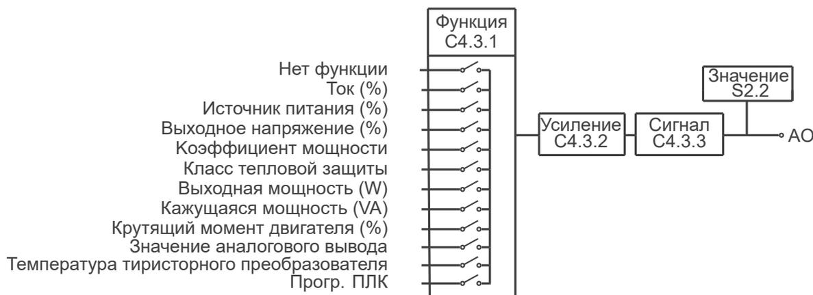
Рисунок 11.12: Блок-схема аналогового выхода
