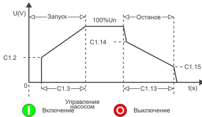
Рисунок 13.11: Запуск с управлением насосом
