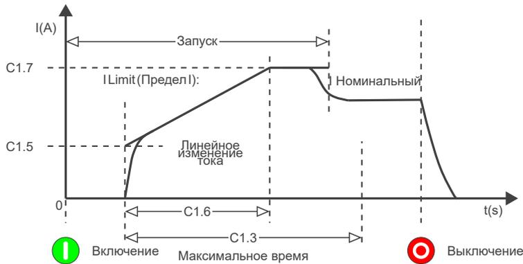
**Рисунок 11.5:** Запуск с линейным изменением тока и пониженным начальным значением
