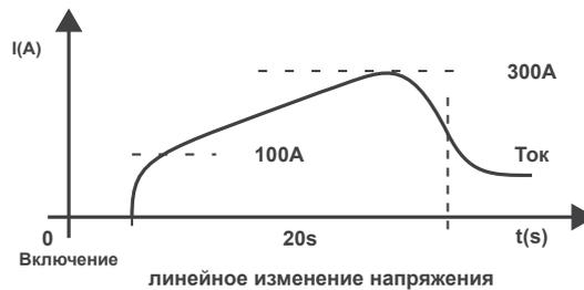
Рисунок 13.24: Пример кривой тока при запуске с линейным изменением напряжения
