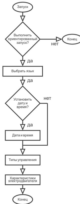
Рисунок 12.1: Последовательность программирования ориентированного запуска.
