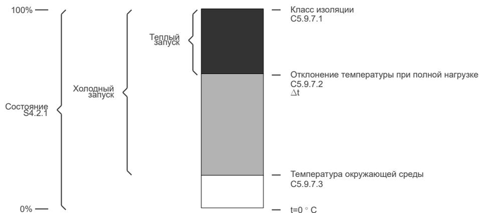
Рисунок 11.23: Области температуры электродвигателя для класса изоляции
