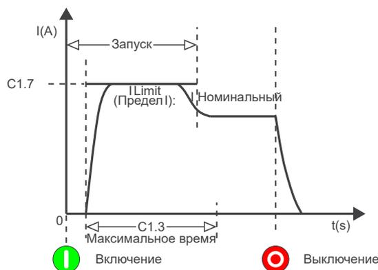
Рисунок 11.4: Линейное ускорение за счет ограничения тока
