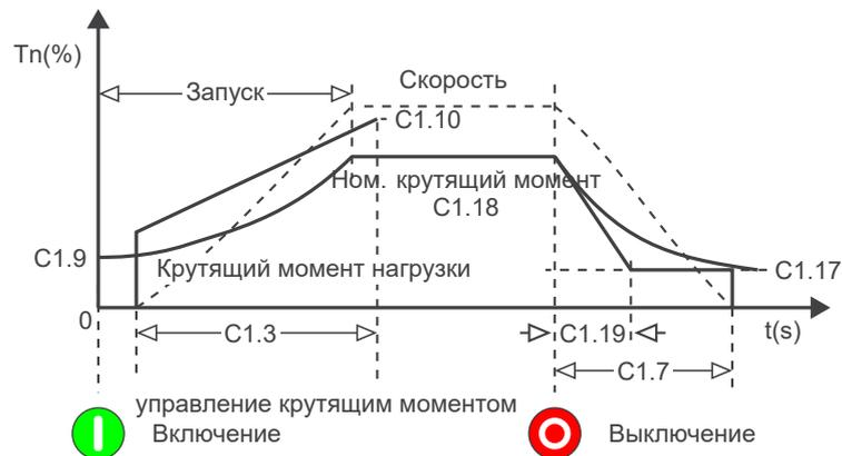
Рисунок 13.22: Остановка гидравлического насоса с квадратичным крутящим моментом (трехступенчатое регулирование)
