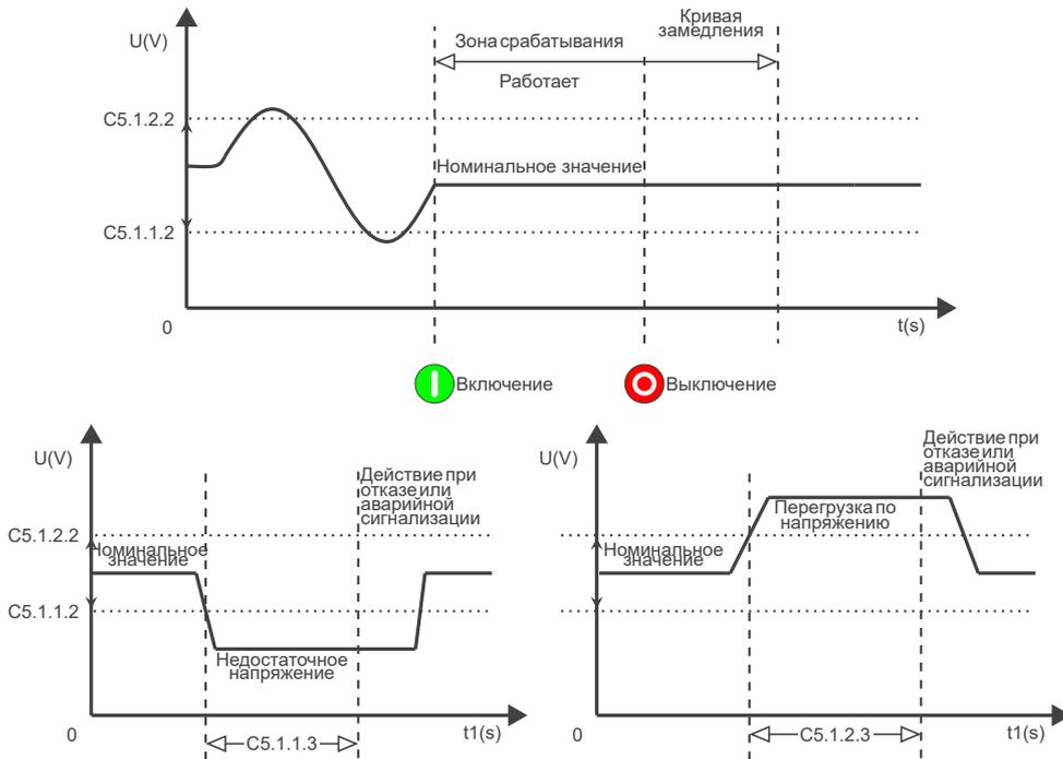
Рисунок 11.13: Уровни срабатывания при повышенном или пониженном напряжении
