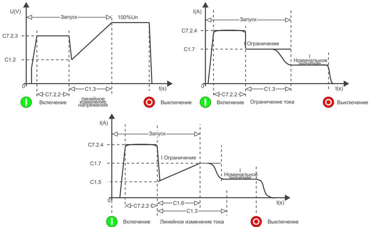
Рисунок 11.30: Импульс пускового крутящего момента — резкий запуск — настройки
