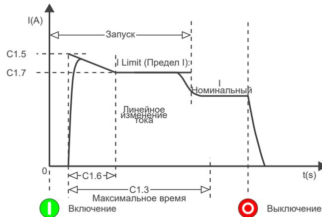
Рисунок 13.6: Запуск с линейным изменением тока и повышенным начальным значением.
