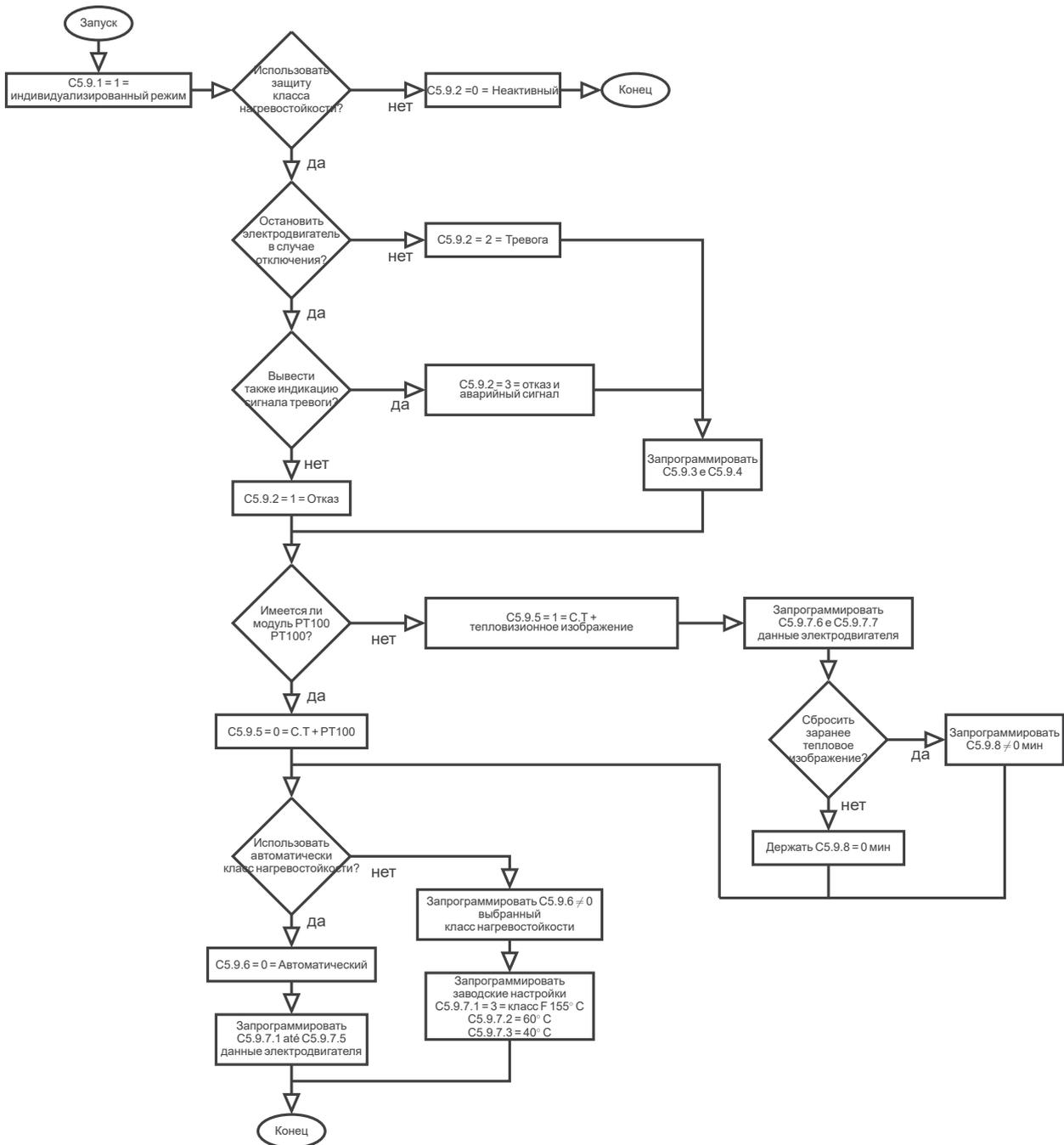
Рисунок 11.21: Последовательность программирования теплового класса защиты — индивидуализированный режим
