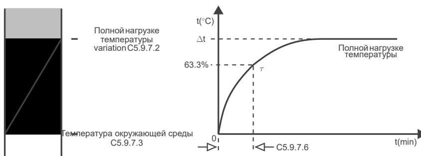
Рисунок 11.25: Константа нагрева электродвигателя при номинальном токе
