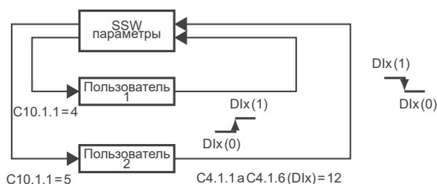
Рисунок 11.11: Подробные сведения о выполнении функции «Загрузка пользователя 1/2»
