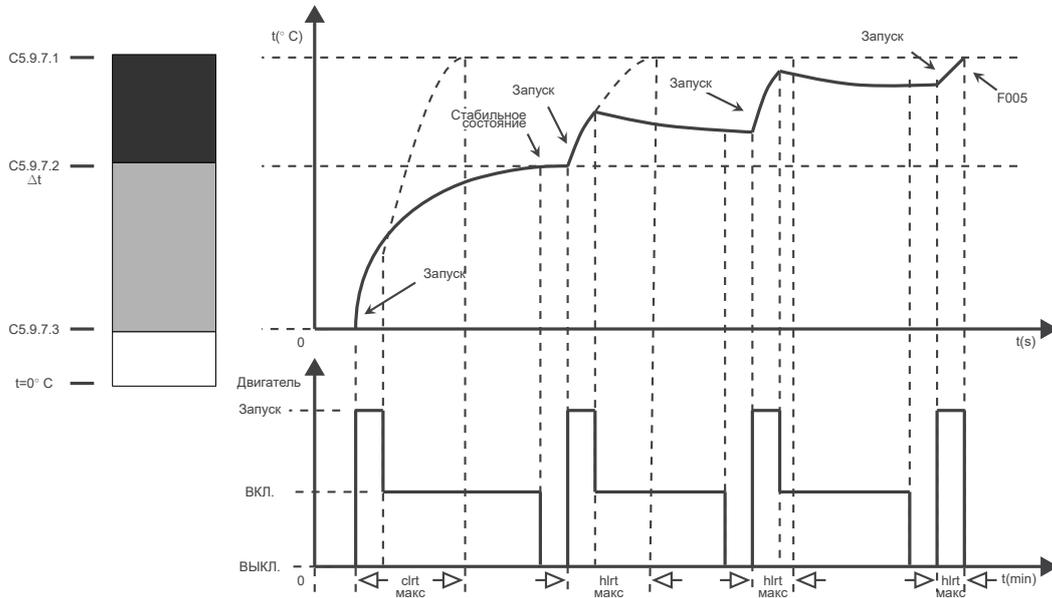
Рисунок 11.24: Нагрев электродвигателя
