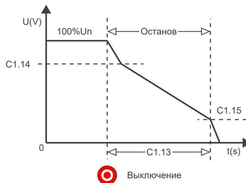
Рисунок 11.9: Линейное замедление за счет изменения напряжения
