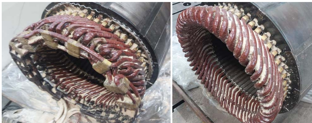
Figura 13: Muestra contaminada con aserrín fino húmedo (Fuente: WEG)
