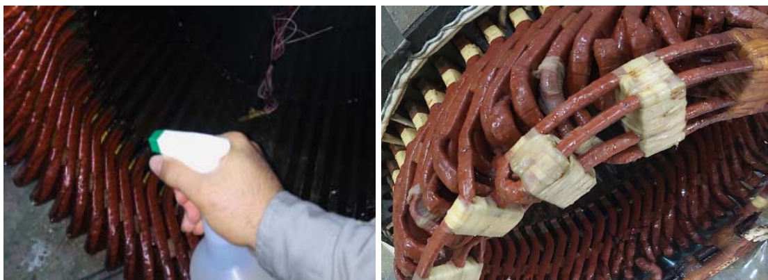
Figura 12: Muestra de estator de alta tensión - Contaminado (Fuente: WEG)
