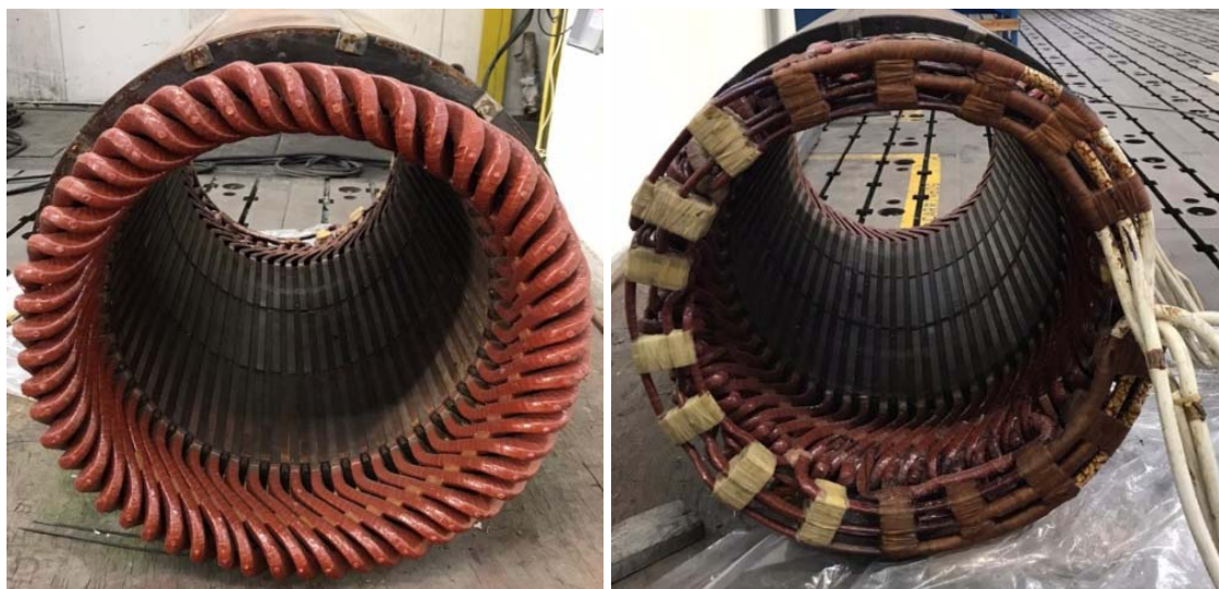
Figura 11: Muestra de estator de alta tensión (Fuente: WEG)
