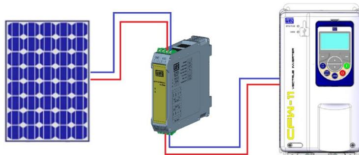
Figura 5.2 – Detecção de irradiação solar usando o Detector Solar
